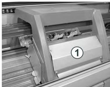
2) Saugrohre am Schlittenwagen entfernen.
