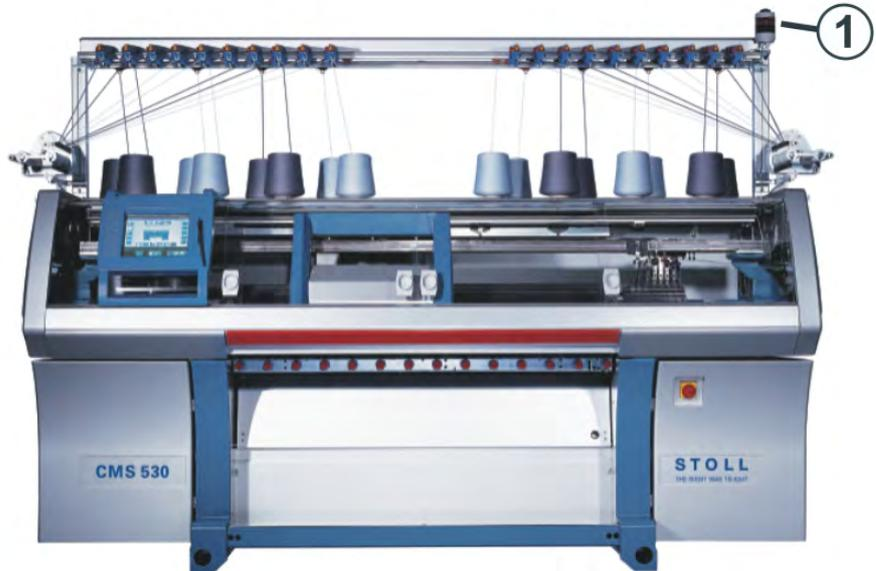
Die Signalleuchte (1) zeigt den Betriebszustand der Strickmaschine an.
