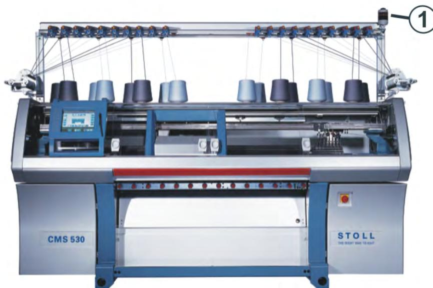
La lámpara indicadora (1) muestra el estado operativo de la máquina de tejer.
