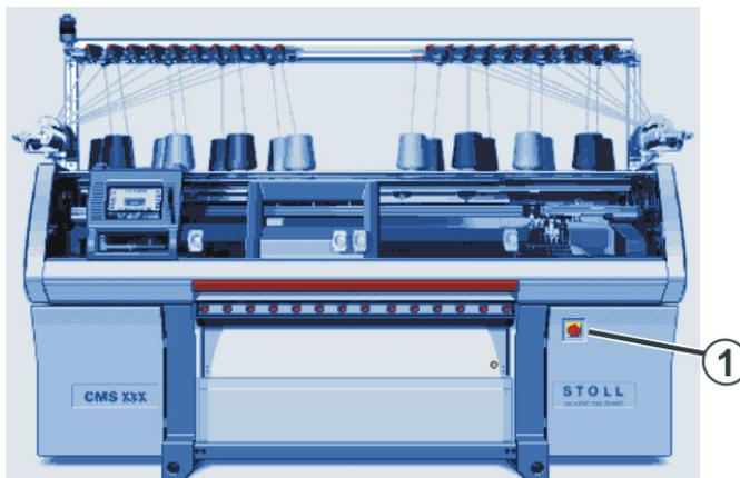
**Embrayage de la machine avec la barre d'embrayage**
