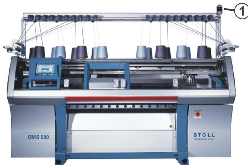
La lampe témoin (1) indique l'état de fonctionnement de la machine à tricoter.
