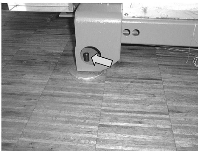
Fig. 4-12 用于找正编织机的平头螺丝
