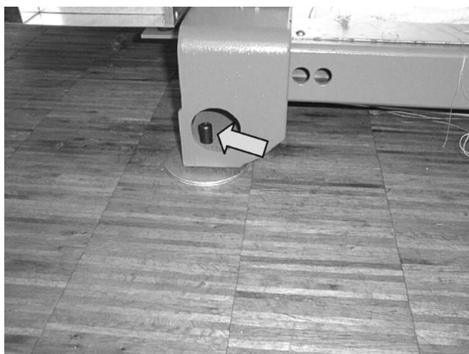
*Fig. 4-12 Tiges filetées servant à aligner la machine*
