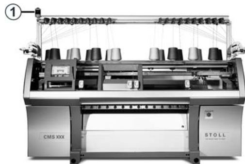
Fig. 3-5 Lampada di segnalazione (1)
