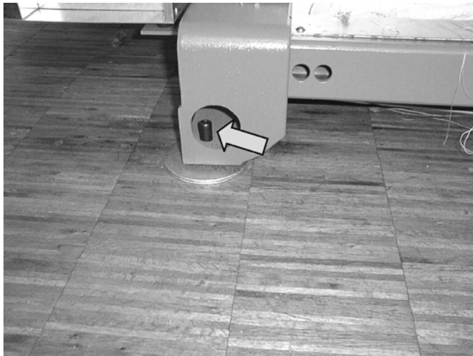
Fig. 4-12 vītņtapas mašīnas nolīmeņošanai
