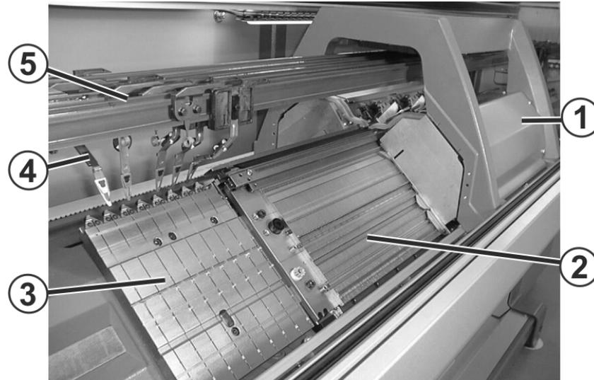
Fig. 3-2 Exibição do interior da máquina de tricotar
