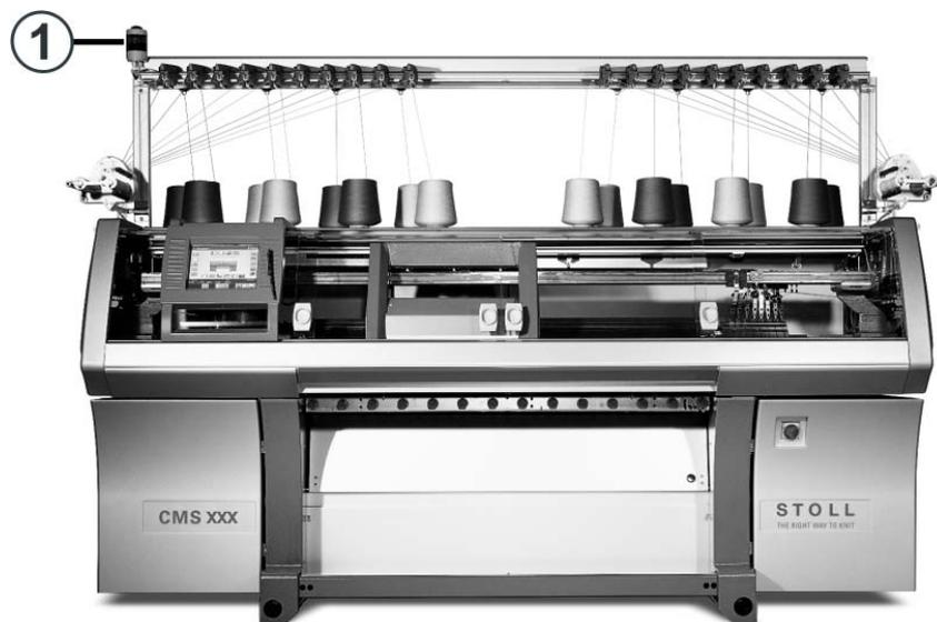
Fig. 4-17 Lâmpada de sinalização do estado da máquina
