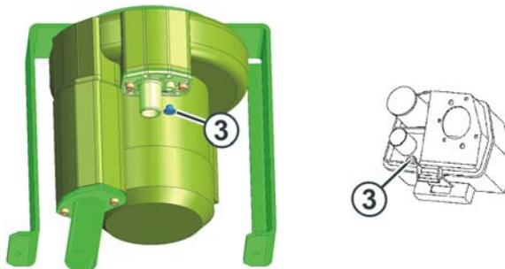
Fig. 4-5 Adaptação da eliminação de cotão (esquerda: a partir do modelo 001, direita: modelo 000)
