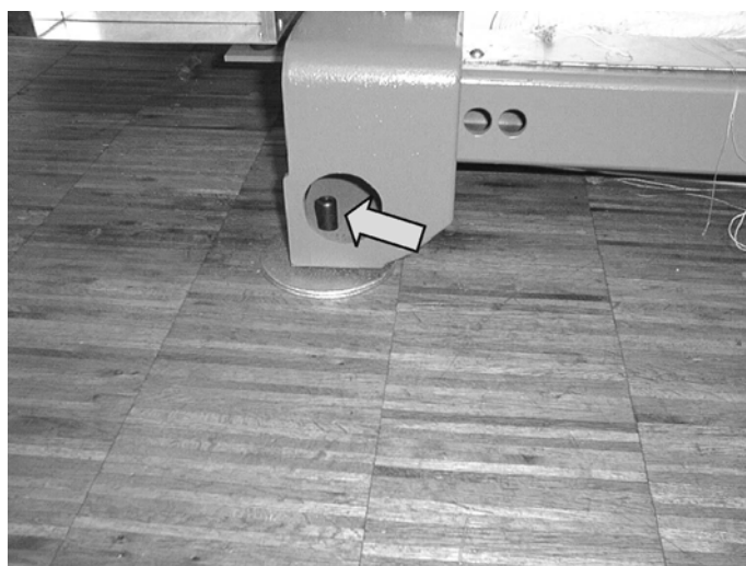
Fig. 4-12 Știfturile filetate pentru alinierea mașinii
