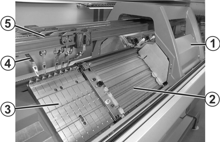
Fig. 3-2 Вид на внутреннюю часть вязальной машины
