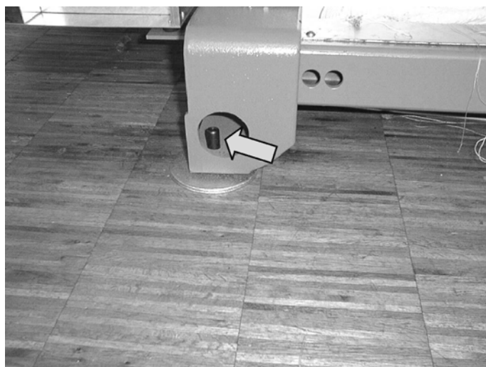
Fig. 4-12 Установочные винты для установки машины по уровню
