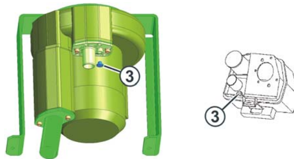
Fig. 4-5 Anpassen der Flusenentsorgung (links: ab Baumuster 001, rechts: Baumuster 000)
