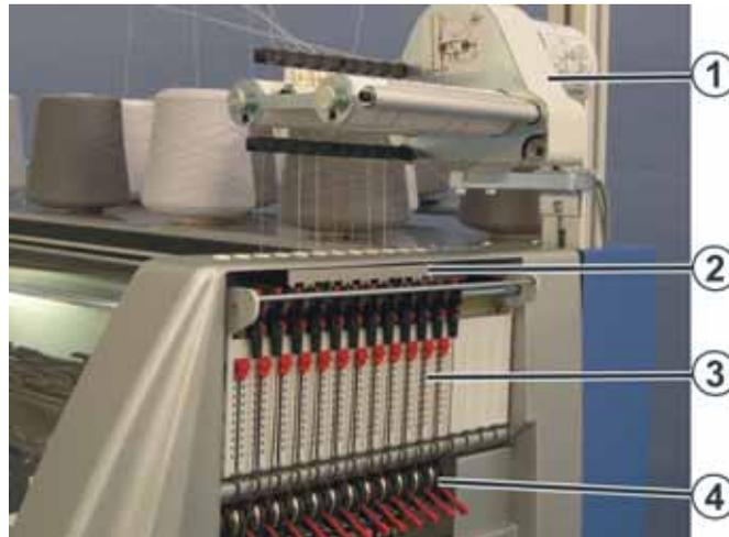
Fig. 2-6 Seitliche Fadenführung
