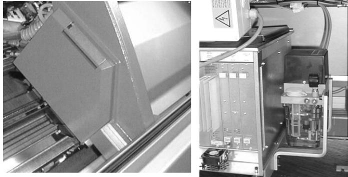
Fig. 2-16 Zentralschmierung am Schlitten, rechts: Ölversorgung
