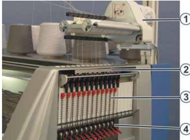
Fig. 2-8 Seitliche Fadenführung
