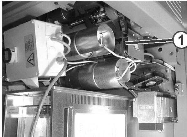
Fig. 2-26 Motor del variador
