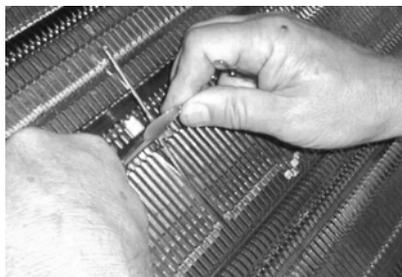
Fig. 6-7 Insertar una pieza de acoplamiento
