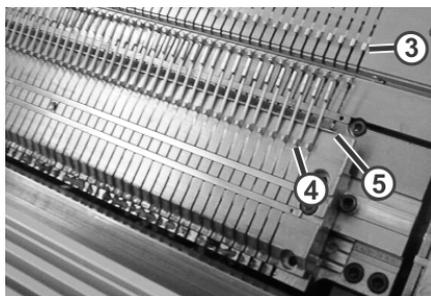
Fig. 6-30 Levage des platines de sélection
