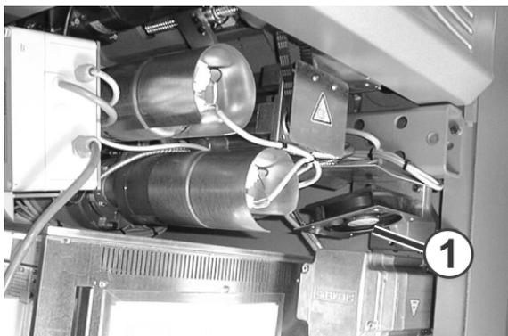
Fig. 5-12 Ventilateur de la commande principale
