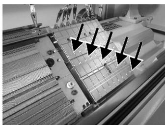
Fig. 5-22 Huilage du dispositif de pinçage et de coupe
