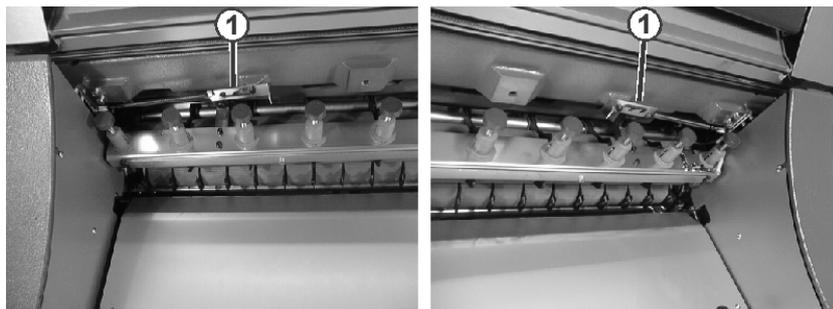
Fig. 4-14 Tôle crantée
