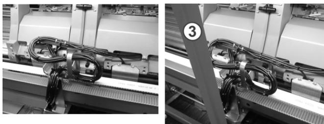
Fig. 4-60 Placer le jeu de câbles dans la pièce de serrage
