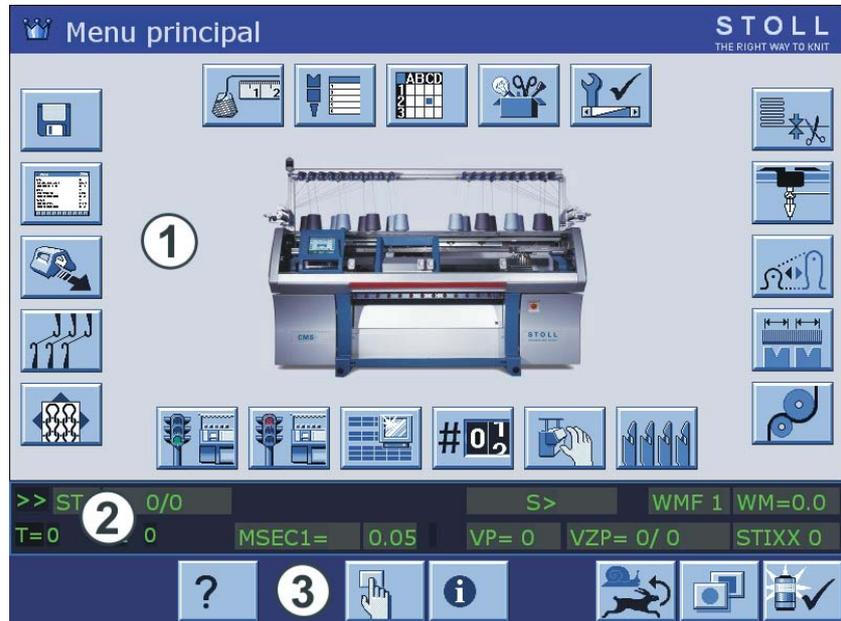
Fig. 2-35 Structure de l'interface de commande
