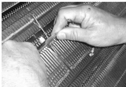
Fig. 6-7 Insérer une pièce d'accouplement
