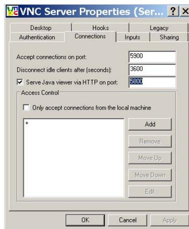
Fig. 11-3 Fenêtre "VNC Server Properties (Service-Mode)" avec l'onglet "Connections"
