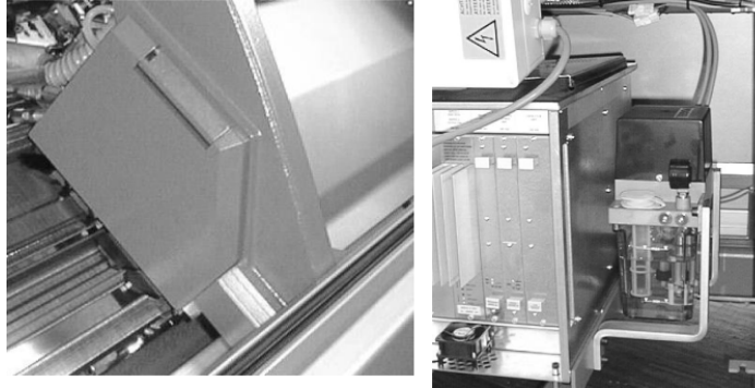
Fig. 2-16 Lubrificazione centrale sul carro, a destra: Alimentazione di olio Questa lubrifica i talloni di lavoro delle platine di abbattaggio, del pezzo d'accoppiamento e della platina intermedia. Tutti gli altri punti di lubrificazione devono essere lubrificati manualmente.
