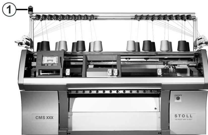
Fig. 2-33 Lampada di segnalazione
