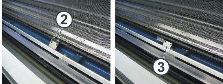
Fig. 6-18 连接脉冲发生器轨道
