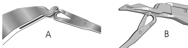
Fig. 4-51 针钩和转换件的移动位置
