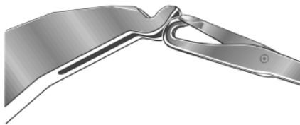
Fig. 4-60 针钩和转换件的移动位置
