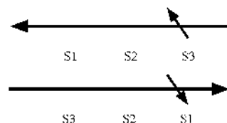
Fig. 2-31 移动顶部: 1. 动程向左边; 底部: 2. 动程向右边
