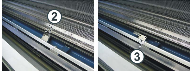
Fig. 6-16 连接脉冲发生器轨道
