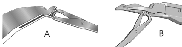
Fig. 4-53 针钩和转换件的移动位置
