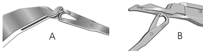
Fig. 4-53 Umhängeposition von Umhängeteil und Nadelkopf
