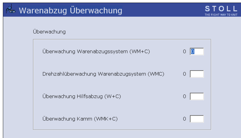
Fig. 4-16 Fenster "Warenabzug Überwachung"
