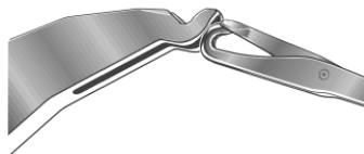
Fig. 4-60 Umhängeposition von Umhängeteil und Nadelkopf
