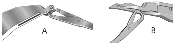
Fig. 4-53 Posición de transferencia de la pieza de transferencia y la cabeza de la aguja
