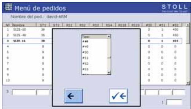
Fig. 3-31 Ventana de ajuste para modificar el conmutador del raport y el contador
