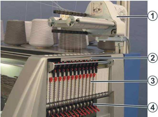
Fig. 2-8 La guía del hilo lateral
