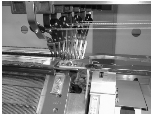
Fig. 4-6 Desplazar los guiahilos
