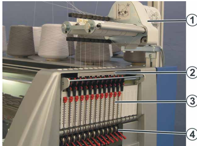
Fig. 2-6 La guía del hilo lateral
