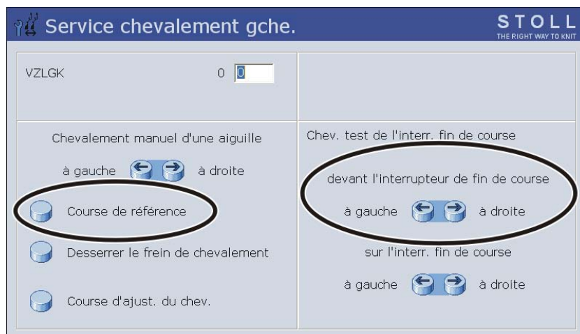
Fig. 5-13 Fenêtre "Service chevalement gauche"
