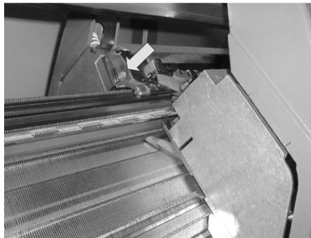
Fig. 2-15 Elimination de la peluche et récipient à peluches (modèle 000)
