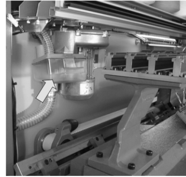
Fig. 2-15 Elimination de la peluche et récipient à peluches (modèle 000)
