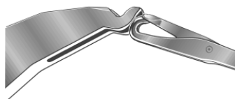
Fig. 4-58 Position de report de la pièce d'entraînement et du crochet d'aiguille
