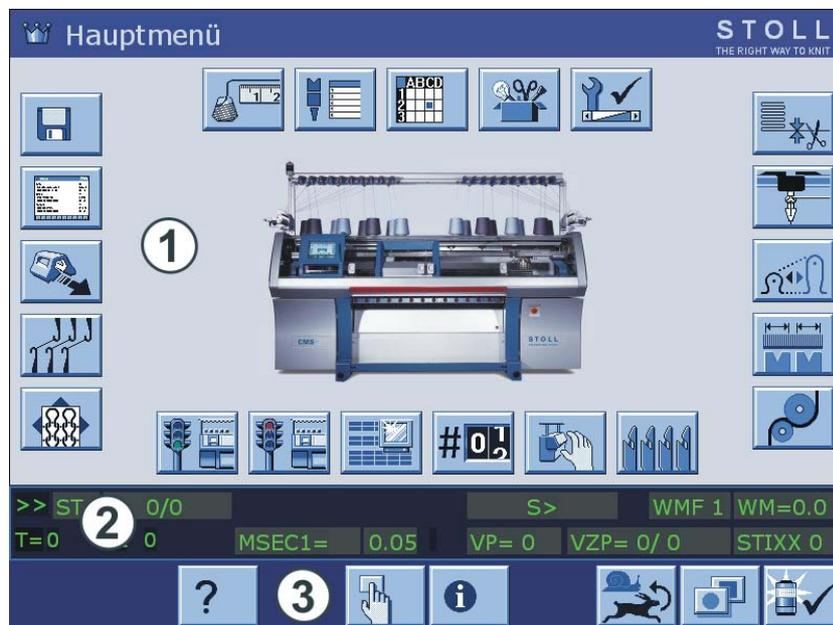
Fig. 2-32 Aufbau der Bedienoberfläche
