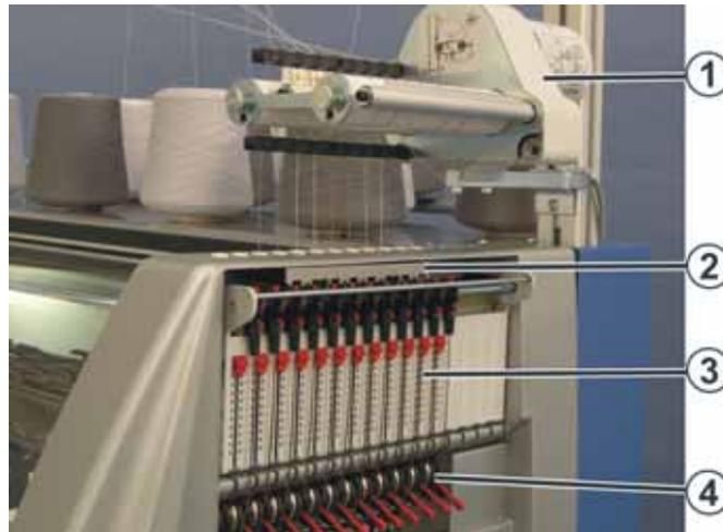
Fig. 2-8 Seitliche Fadenführung
