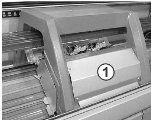
Fig. 6-24 Revestimiento del carro
