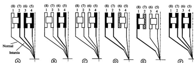
Fig. 6-39 Combinaciones posibles para guíahilos normales y guíahilos de intarsia
