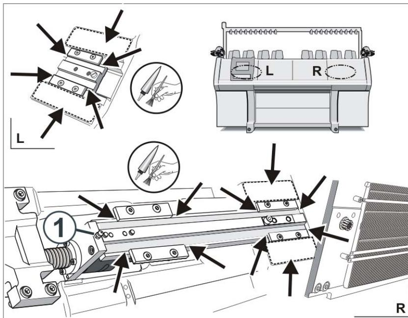
Fig. 5-29 Engrasar el dispositivo de variador
