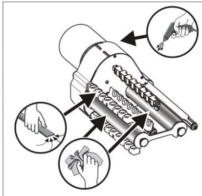
Fig. 5-11 Limpieza del alimentador de fricción
