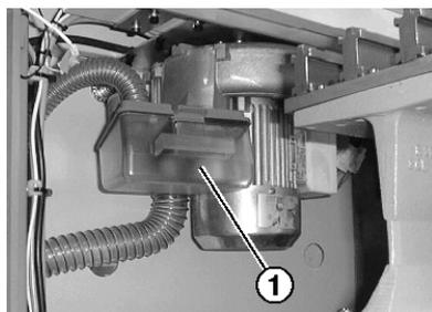
Fig. 5-4 Depósito de pelusas de la aspiración
