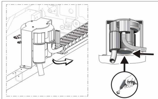
Fig. 5-2 Limpieza de la cubierta del motor
