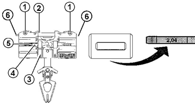
Fig. 4-67 Desmontaje de la plaquita de presión
