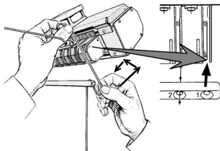
Fig. 3-13 Recorrido del hilo a través del aparato STIXX
