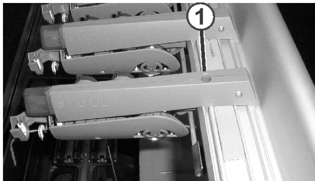
Fig. 6-43 Desmontaje de un dispositivo de control del hilo
