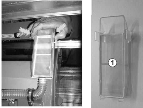
Fig. 5-1 Depósito de pelusas y filtro
