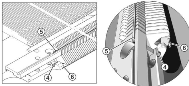
Fig. 6-9 Recambio de una platina
