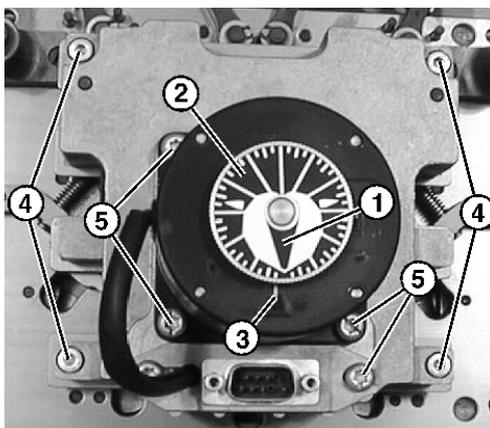
Fig. 6-33 Quitar el motor de paso a paso
