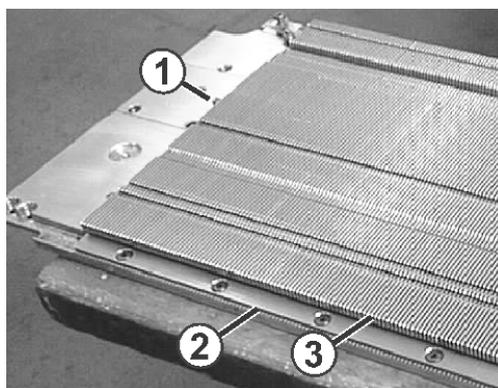
Fig. 6-19 Reparación de una fontura compuesta
