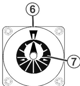
Fig. 6-34 Posición inicial del motor paso a paso
