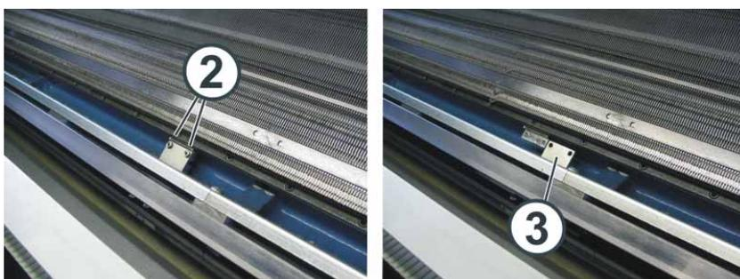
Fig. 6-11 Conexión del carril del generador de impulsos
