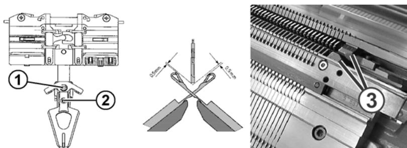
Fig. 4-65 Ajuste de los guíahilos de intarsia
