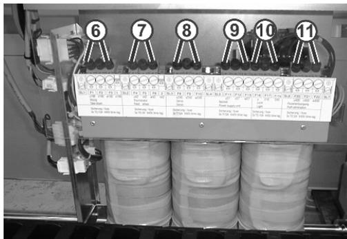
Fig. 6-56 Fusibles del transformador en la parte posterior de la máquina
