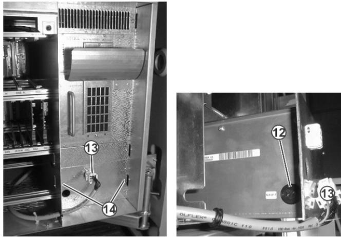
Fig. 6-54 El fusible de batería (12) debajo de la fuente de alimentación
