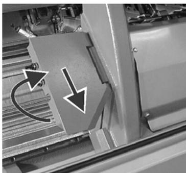
Fig. 6-2 Posición de montaje de la lubricación central
