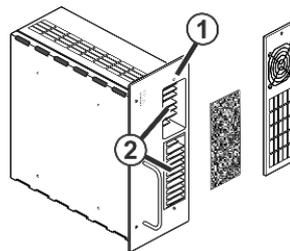
Fig. 5-14 Ventilador de la fuente de alimentación
