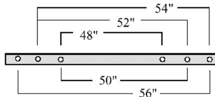
Fig. 4-48 Anchuras de acoplamiento en la CMS 933
