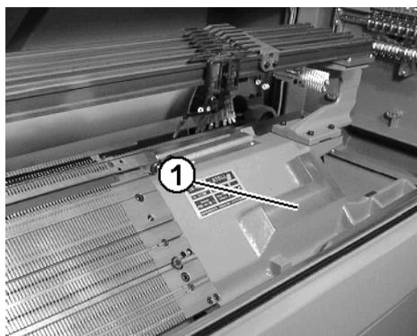
Fig. 6-28 Superficie de apoyo de la placa del carro
