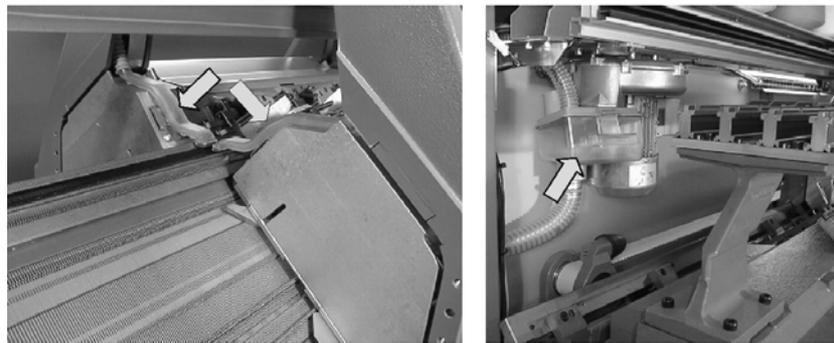
Fig. 2-13 Eliminación y depósito de pelusas (modelo de construcción 000)
