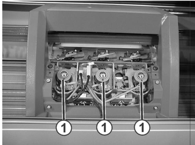
Fig. 2-21 Motor de paso a paso para el ajuste del cerraje del punto
