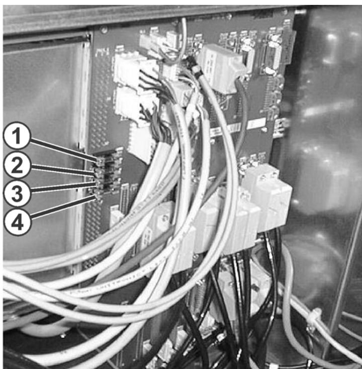
Fig. 6-53 Fusibles en la parte posterior de la unidad de mando
