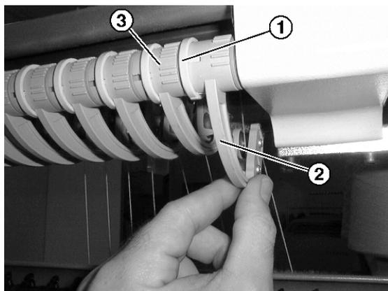
Fig. 4-9 Ajuste de la alimentación del hilo en el alimentador de fricción
