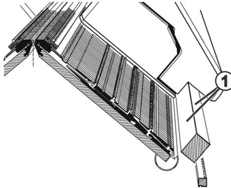
Fig. 5-24 Aceitado de la barra de guía del carro
