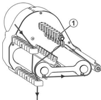
Fig. 4-8 Ajuste de la alimentación del hilo en el alimentador de fricción
