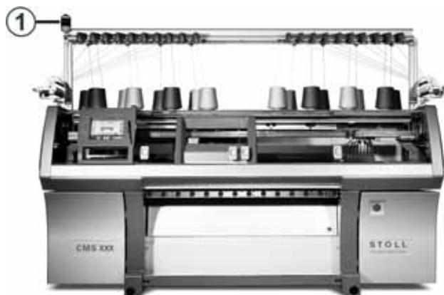
Fig. 2-30 Lámpara de señalización
