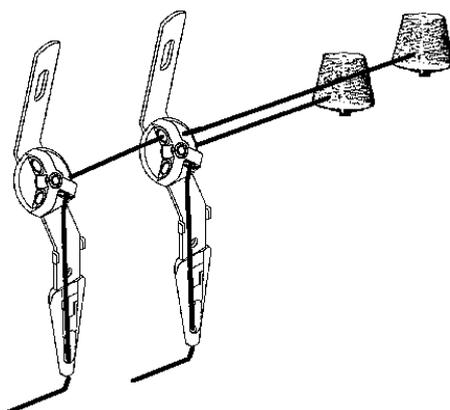
Fig. 3-15 Enhebrar en varios guíahilos de una traza
