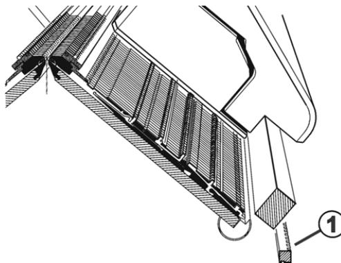
Fig. 5-25 Engrase de las barras ranuradas del generador de impulsos
