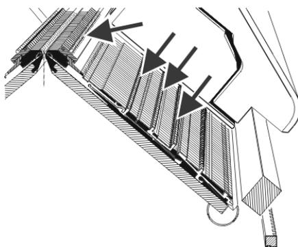
Fig. 5-18 Puntos de lubricación de la lubricación central
