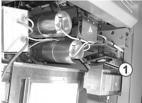
Fig. 5-12 Ventilador del accionamiento principal
