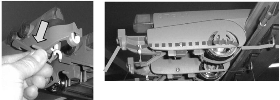
Fig. 3-12 Recorrido del hilo a través del dispositivo de control del hilo
