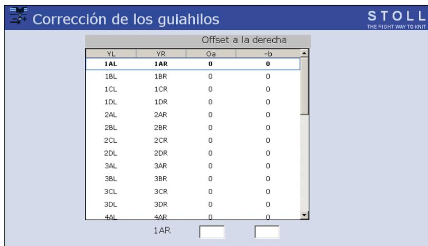
Fig. 4-6 Ventana "Corrección de los guiahilos" para servicio tándem
