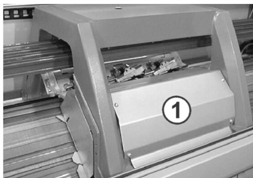
Fig. 6-20 Revestimiento del carro
