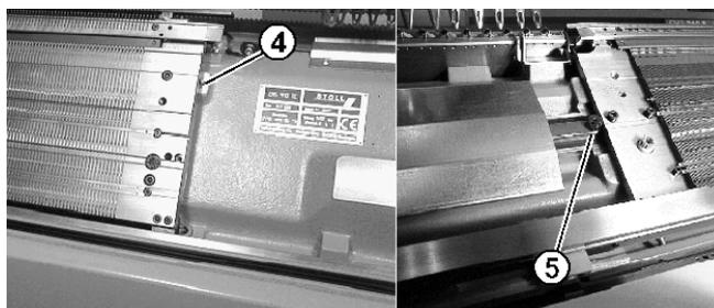
Fig. 6-14 Montaje de la fontura anterior y posterior
