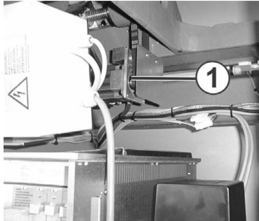
Fig. 2-25 Motor del variador
