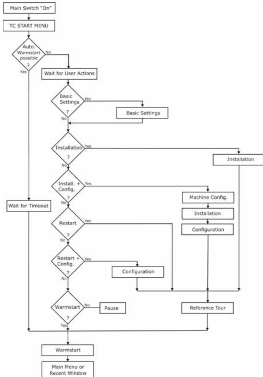
Fig. 7-1 Representación esquemática del procedimiento de inicialización
