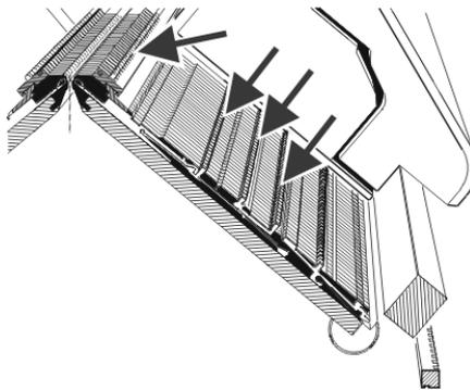
Fig. 2-16 Puntos de lubricación de la lubricación central
