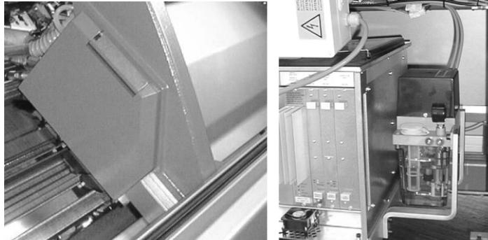
Fig. 2-15 Lubricación en el carro, derecha: Suministro de aceite
