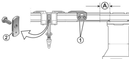
Fig. 6-38 Tornillos del tope de guíahilos
