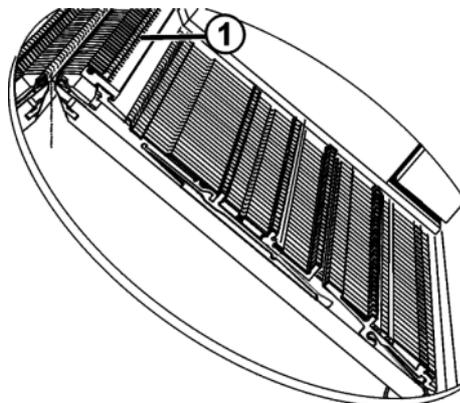
Fig. 5-22 Aceitado de la fontura de las platinas
