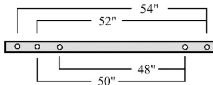
Fig. 4-47 Anchuras de acoplamiento en la CMS 922
