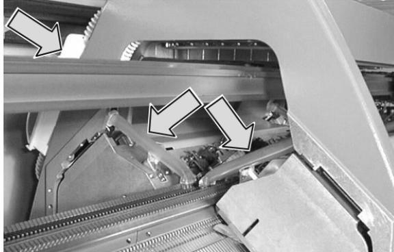
Fig. 2-12 Eliminación y depósito de pelusas (a partir del modelo de construcción 001)
