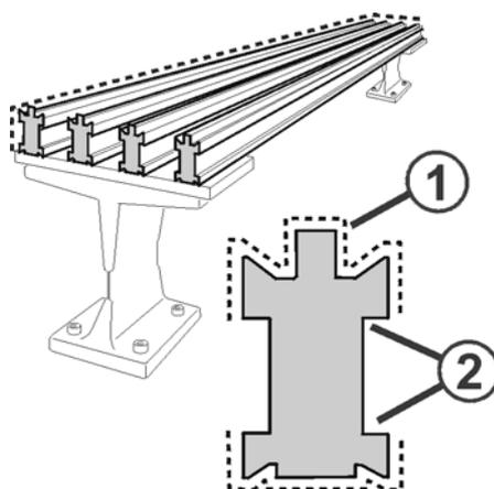
Fig. 5-23 Aceitado de las barras de guíahilos
