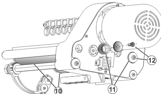
Fig. 6-46 Tornillos para el rodillo de fricción
