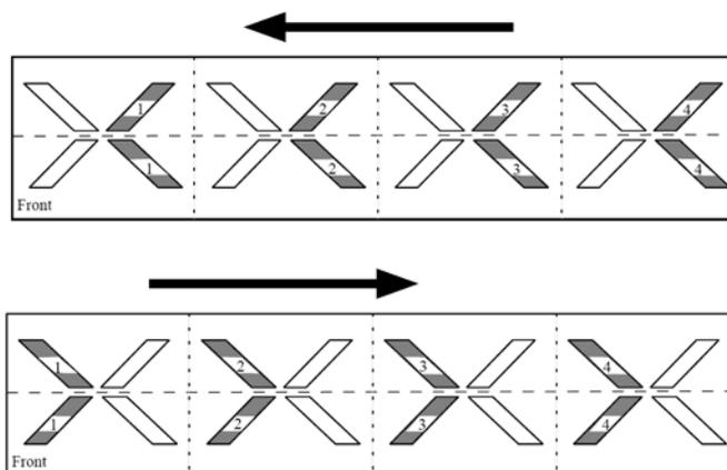
Fig. 4-43 Numeración de las levas de formación para una máquina de 4 sistemas
