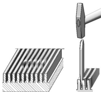
Fig. 6-16 Poner los puentes en posición vertical
