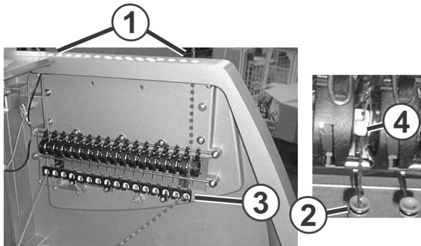
Fig. 3-14 Recorrido del hilo a través de la cubierta de protección lateral
