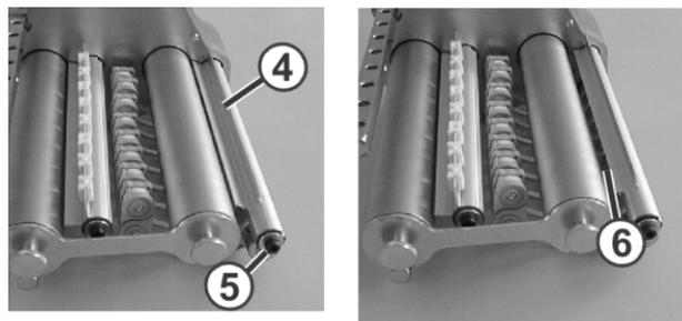
Fig. 4-10 Ajustar la distancia entre la guía de parada y el rodillo de fricción
