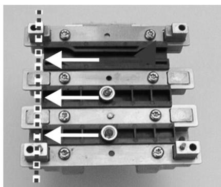
Fig. 6-37 Comprobación de la posición de montaje
