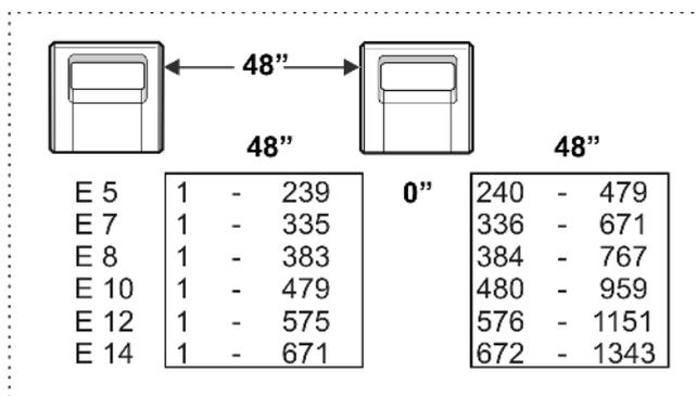
Fig. 4-54 Sector de agujas ancho de acoplamiento 48"
