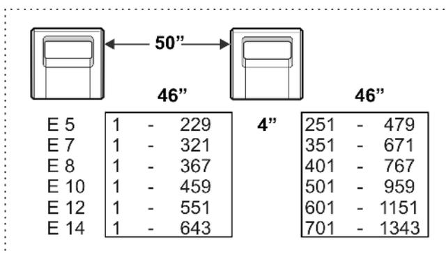
Fig. 4-53 Sector de agujas ancho de acoplamiento 50"
