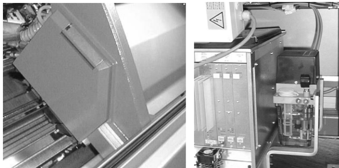
Fig. 2-15 Lubrification centrale au chariot, à droite: Alimentation en huile Elle lubrifie à l'huile les talons de travail des platines d'appui, de la pièce d'accouplement et du verrou intermédiaire. Tous les autres points de lubrification doivent être graissés manuellement.
