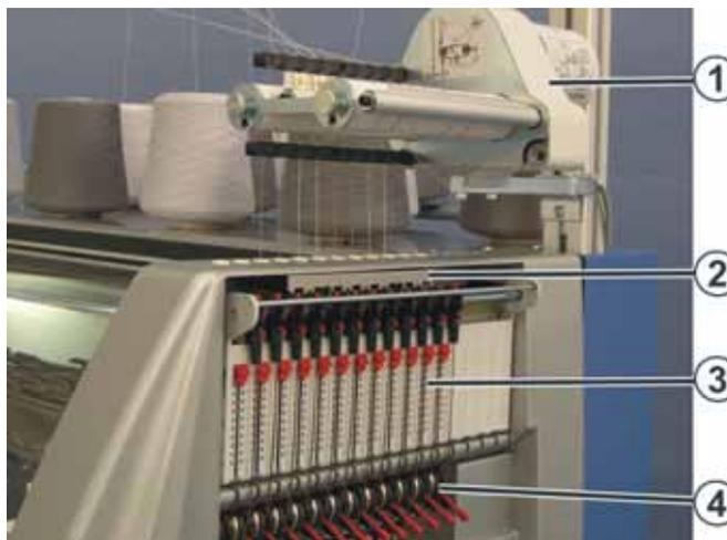
Fig. 2-8 Guida laterale del filo
