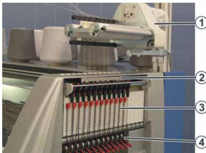
Fig. 2-6 Guida laterale del filo
