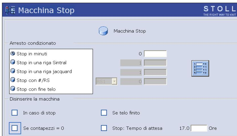
Fig. 3-5 Finestra "Macchina stop"
