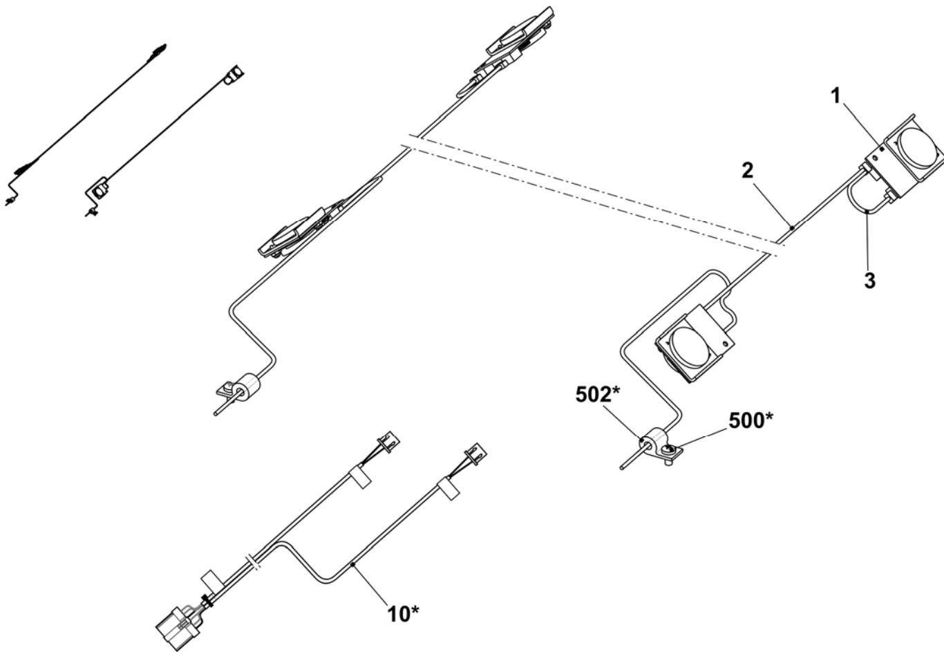
**E16 + E18 + E8.2 + E9.2机器的振动自停装置**
