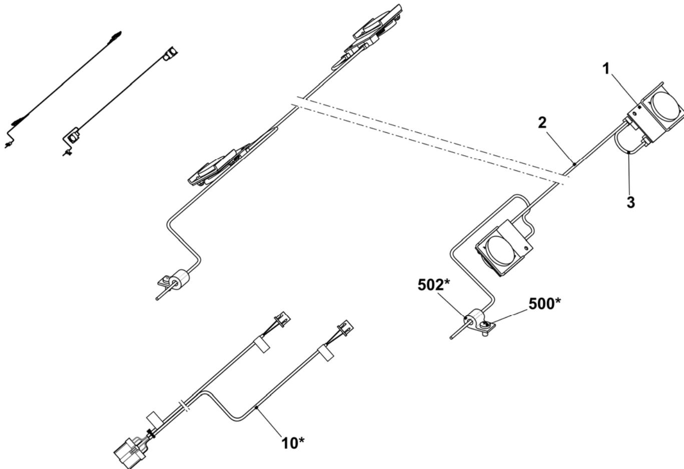
**E16 + E18 + E8.2 + E9.2机器的振动自停装置**
