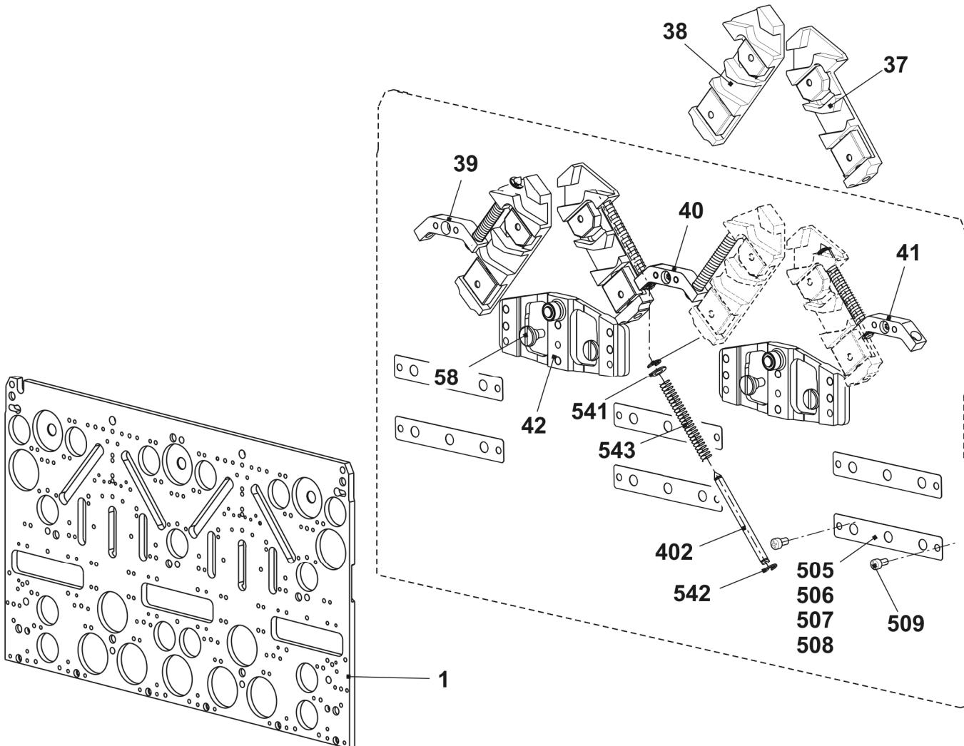
█ Schlossteile für enge Kopplung E10 + E10m.12 + E12 + E12m.10 +E6.2 mg + E14 + E7.2 mg + E16 + E18 + E8.2 mg [→ 107]
