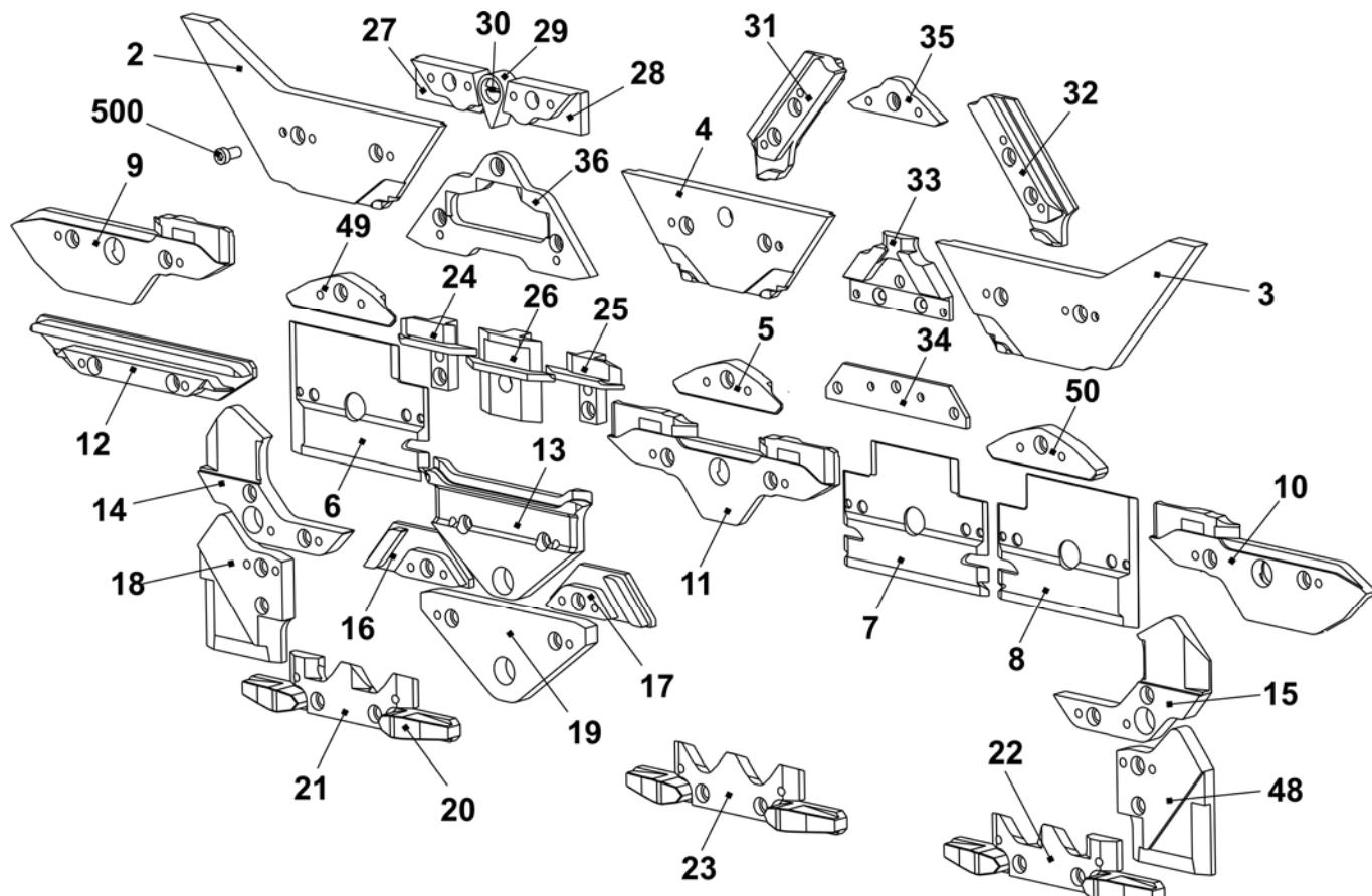
**Cams for narrow coupling E5 + E5m.4 + E7m.5 + E2,5.2 k&w + E2,5.2 mg + E3,5.2 k&w + E3,5.2 mg + E5.2 k&w + E5.2 mg + E7 + E8 + E7m.8 + E8m.7**
