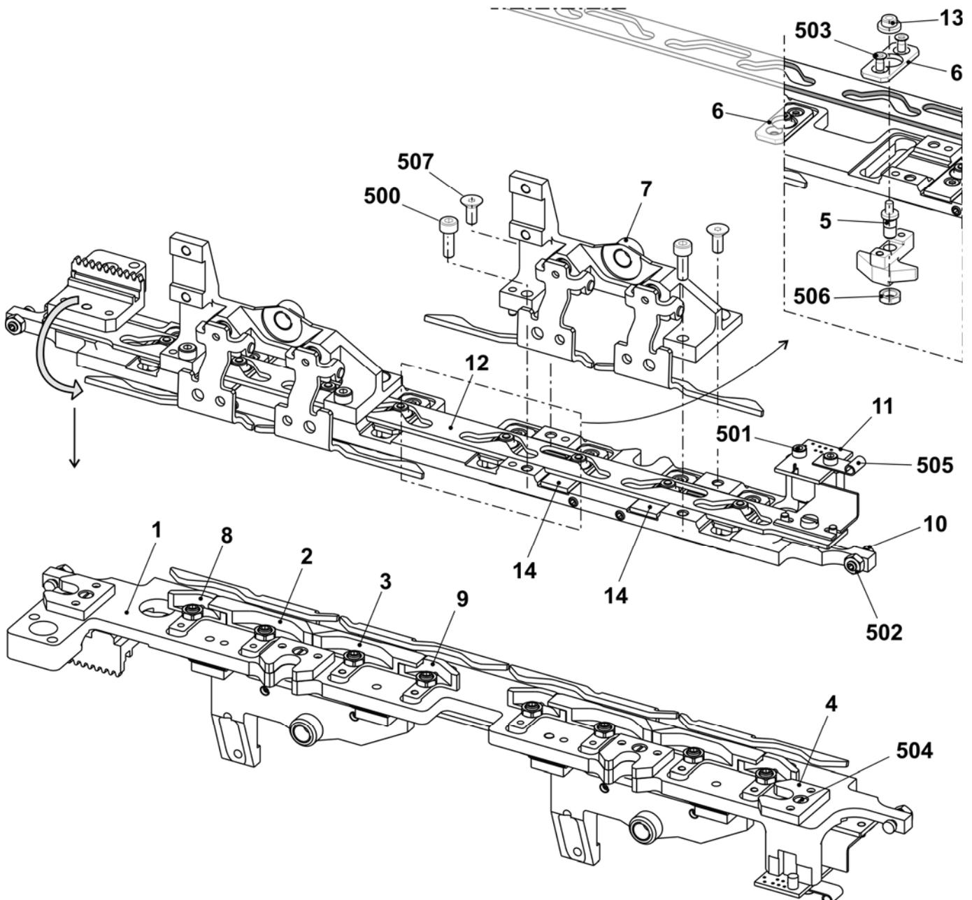
**Platinenschloss E5.2 kw + E6.2 kw**
