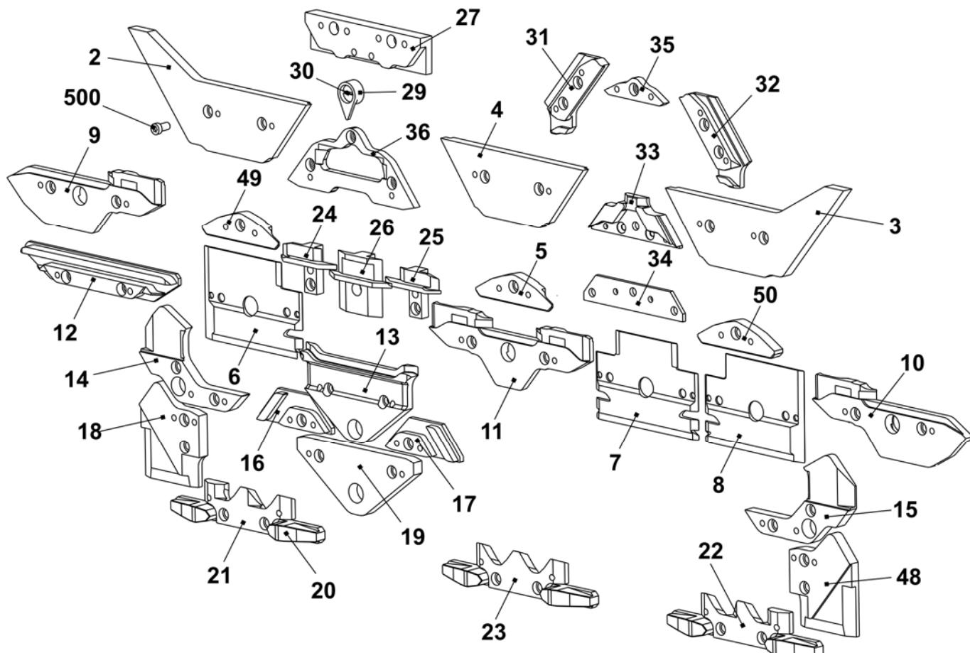
**Schlossteile für enge Kopplung E6.2kw + E7.2kw**
