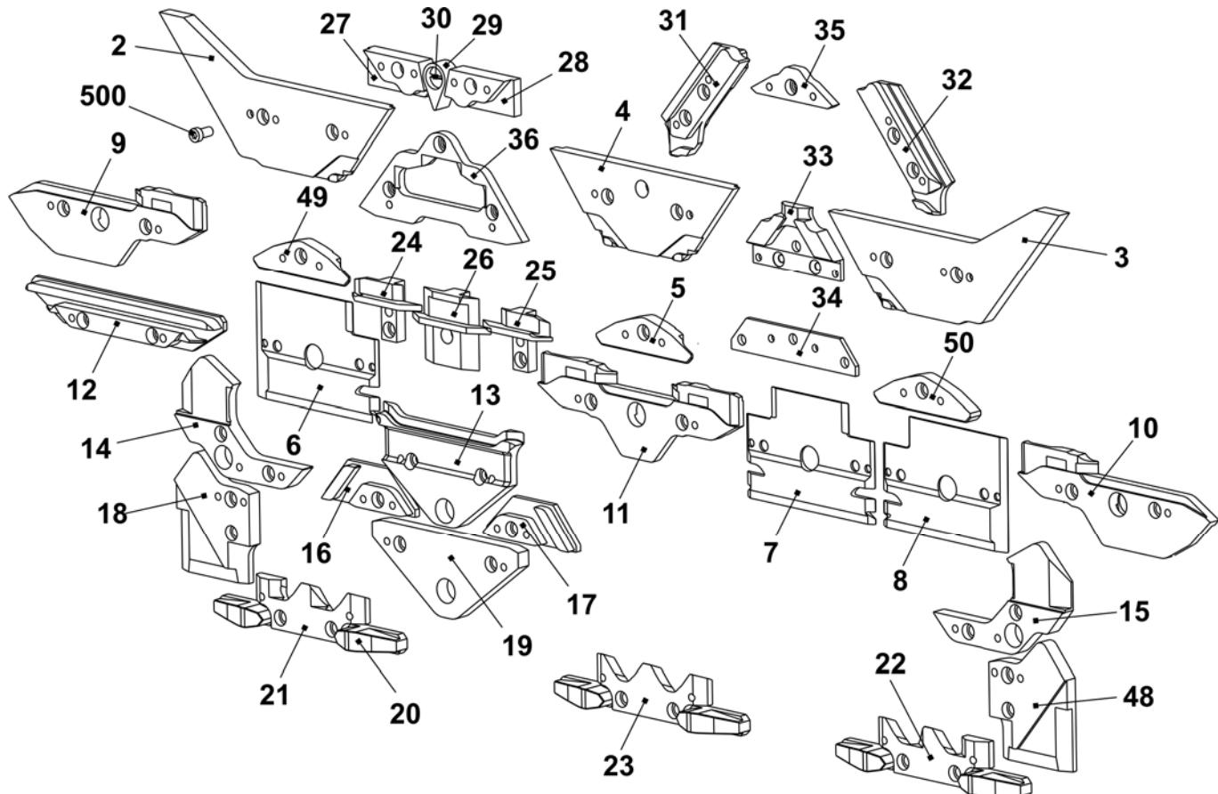
**Schlossteile für enge Kopplung E5 + E7 + E8 + E5m.4 + E7m.5 + E7m.8 + E8m.7 + E2,5.2 + E3,5.2 + E5.2**
