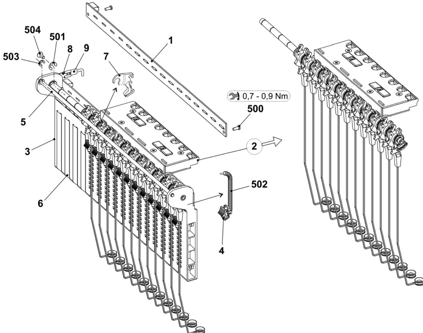
**Fadenbremse und Fadenumlenker**
