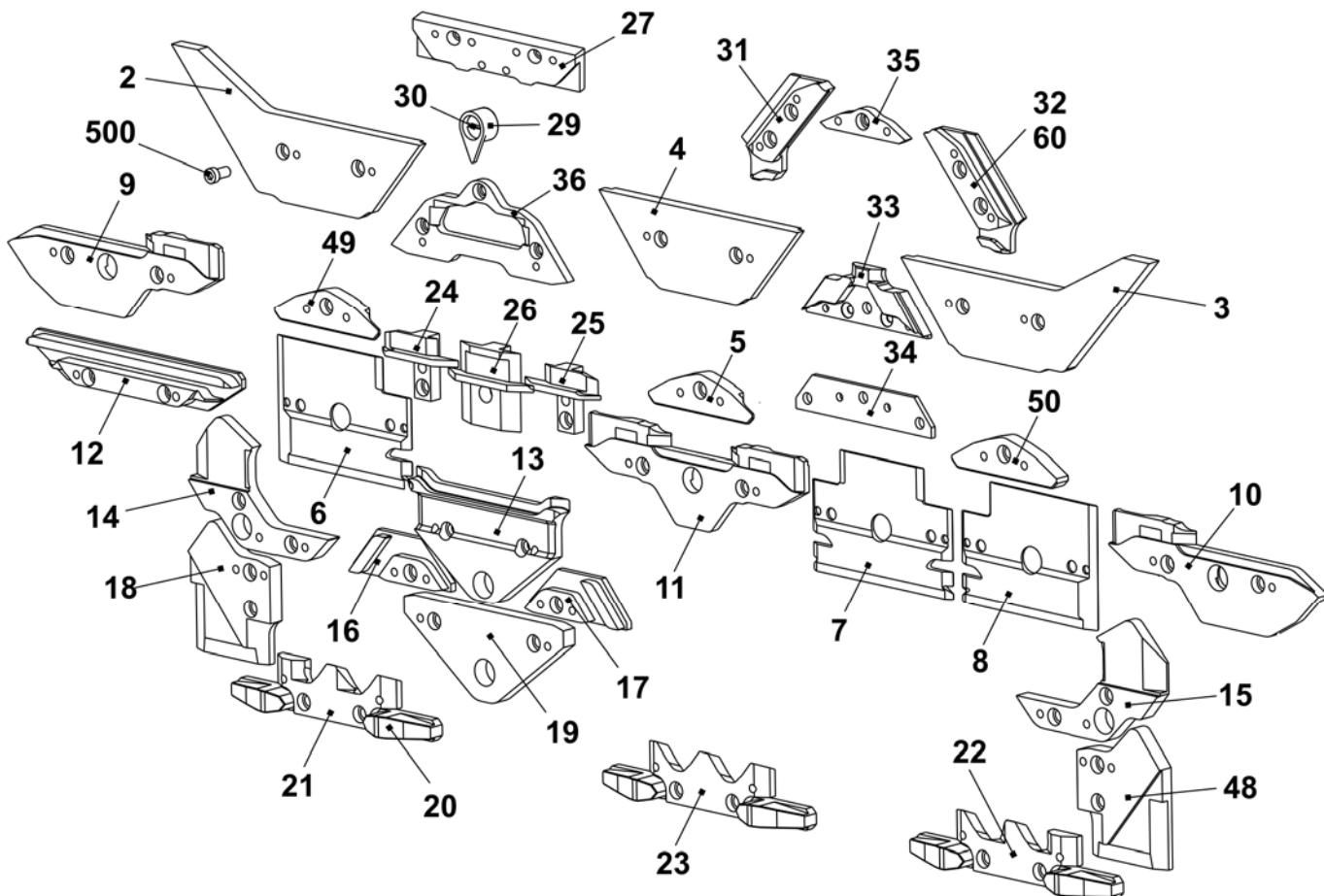
**Schlossteile für enge Kopplung E10 + E12 + E14 + E16 + E18 +
