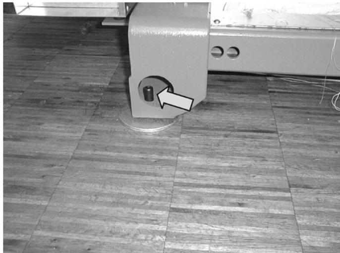
Fig. 4-12 Gewindestifte zum Ausrichten der Maschine
