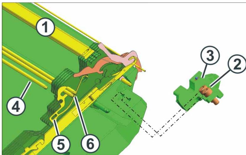
Fig. 6-11 Austausch einer Feder der Niederhalteplatte
