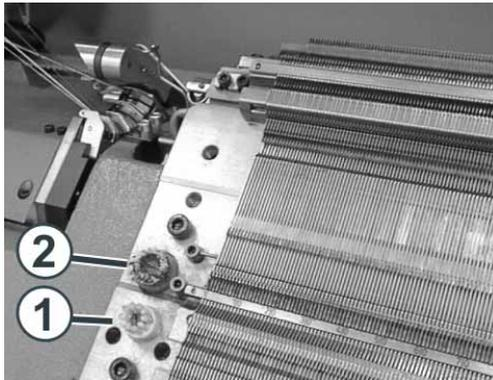
Fig. 2-15 Bürsten zur Reinigung der Auswahlssysteme
