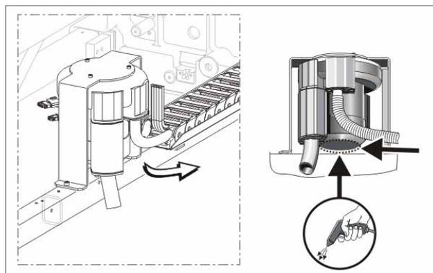
Fig. 5-2 Reinigen der Motorabdeckung
