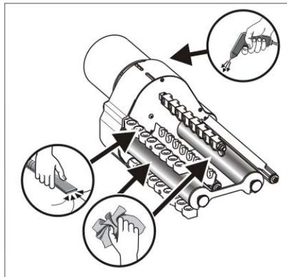
Fig. 5-11 Reinigen des Friktionsfournisseurs
