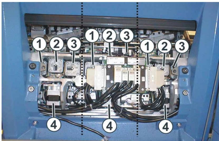
Fig. 2-19 Schrittmotoren im Schlitten
