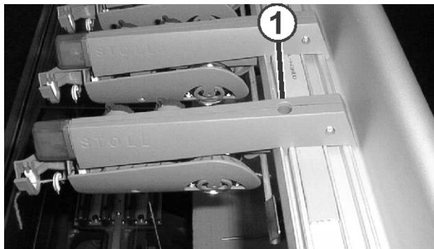
Fig. 6-49 Ausbau einer Fadenkontrolleinrichtung
