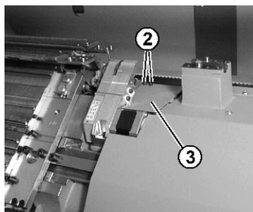
Fig. 6-40 Abdeckung der Fadenklemm- und Schneideinrichtung
