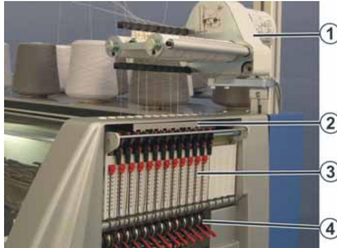
Fig. 2-8 Seitliche Fadenführung
