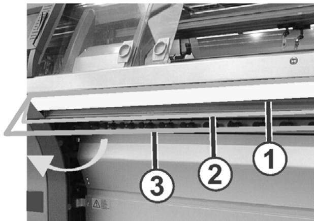
Fig. 3-19 Einrückstange
