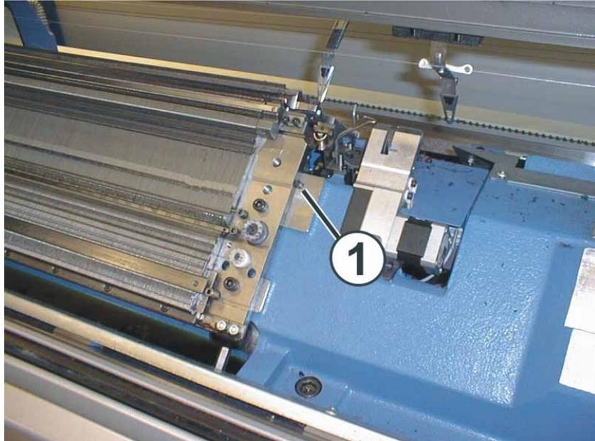
Fig. 6-19 Einbau des vorderen Nadelbetts
