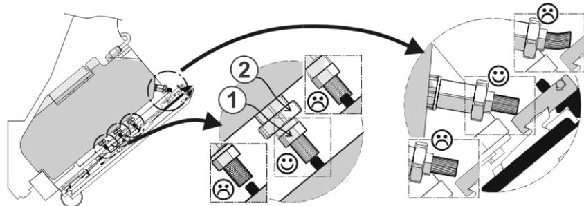
Fig. 4-58 Bürsten der Zentralschmierung
