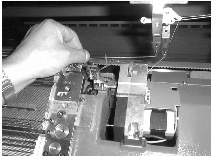
Fig. 3-16 Faden einfädeln
