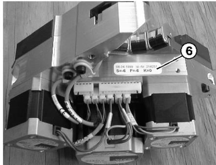
Fig. 6-42 Aufkleber Korrekturwerte
