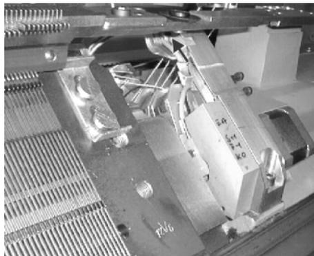
Fig. 5-20 Zahnriemen in Pfeilrichtung spannen
