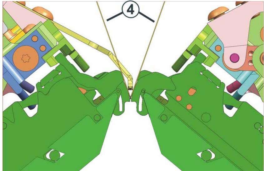
Fig. 4-52 Position des Einstreifers kontrollieren
