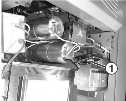
Fig. 5-12 Lüfter Hauptantrieb
