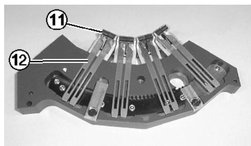
Fig. 5-26 Selektionsgehäuse
