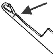
Fig. 5-39 Ölen der Scharniere der Nadelzungen
