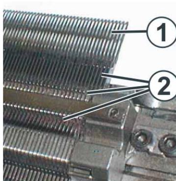
Fig. 5-8 Reinigen des Nadelbetts
