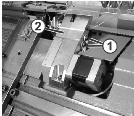
Fig. 5-17 Schrauben des Fingerträgers
