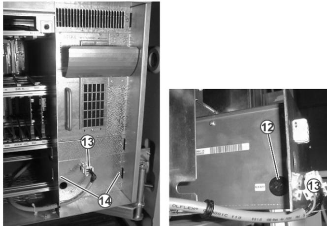
Fig. 6-60 Batteriesicherung (12) unterhalb des Netzgerätes
