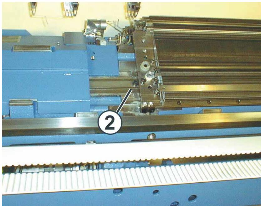
Fig. 6-20 Einbau des hinteren Nadelbetts
