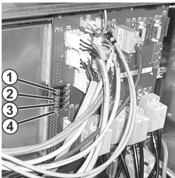
Fig. 6-59 Sicherungen auf Rückseite des linken Steuergerätes
