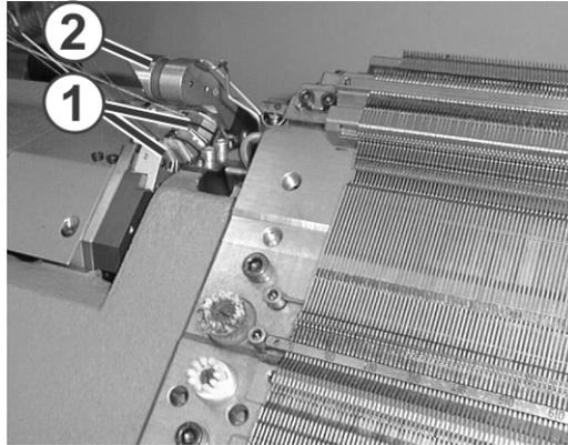
Fig. 2-9 Fadenklemm- und Schneideinrichtung
