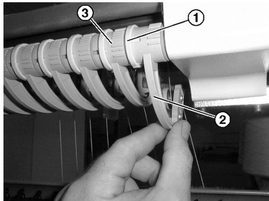
Fig. 4-9 Einstellung der Fadenlieferung am Friktionsfournisseur
