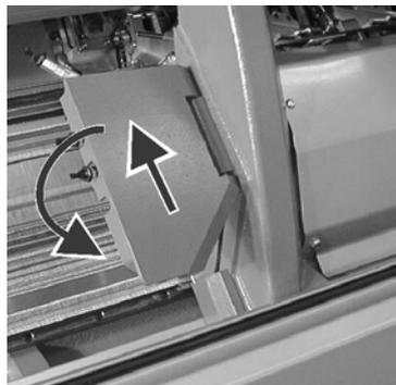
Fig. 6-3 Zentralschmierung in Arbeitsstellung schwenken
