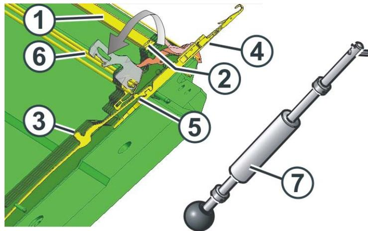
Fig. 6-5 Wechseln von Nadel und Kupplungsteil
