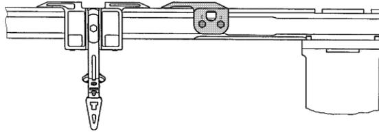
Fig. 6-46 Fadenführerbegrenzer und Fadenumlenker
