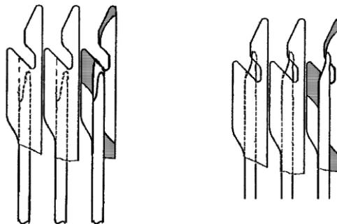
Fig. 2-30 Kammhaken des Kammabzugs mit Schiebern (links offen, rechts geschlossen)
