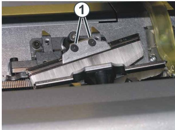
Fig. 4-54 Schrauben der Nadelbürsten
