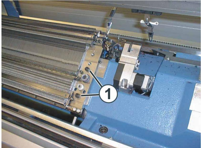
Fig. 6-15 Lösen des Nadelbetts
