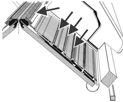
Fig. 5-30 Schmierstellen der Zentralschmierung
