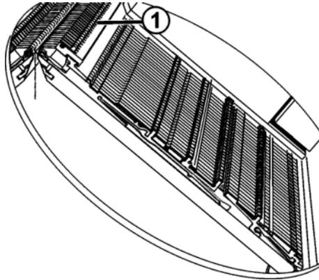
Fig. 5-34 Ölen des Platinenbetts
