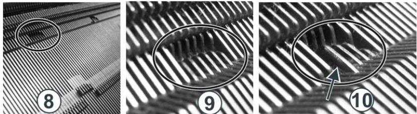
Fig. 6-6 Kontrolle von Nadel und Kupplungsteil
