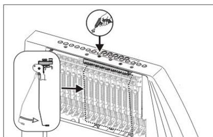
Fig. 5-9 Reinigen der aktiven Fadenklemme
