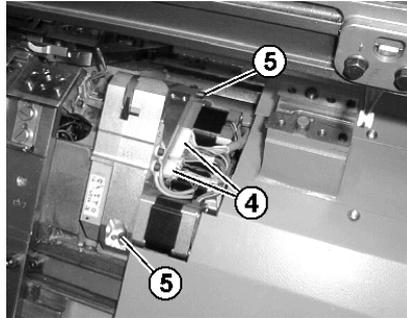
Fig. 6-41 Kabel und Schrauben der Fadenklemm- und Schneideinrichtung
