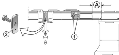
Fig. 6-44 Schrauben des Fadenführerbegrenzers
