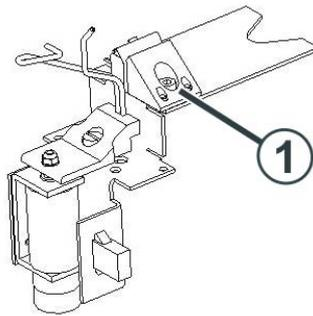
Fig. 4-48 Einstellen der Fadenklemme
