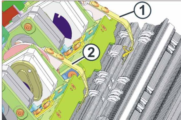
Fig. 2-17 Einstreifer mit Schrittmotor
