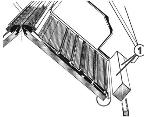
Fig. 5-36 Ölen des Schlittenführungsstabs
