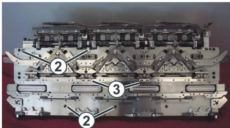
Fig. 6-37 Schrauben für Gusskörper an der Schlossplatte
