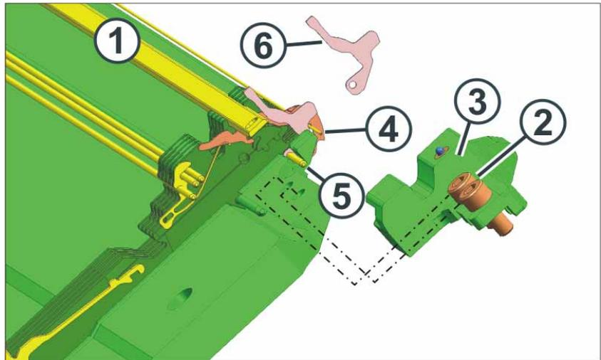
Fig. 6-12 Austausch einer Platine-Garnleiter
