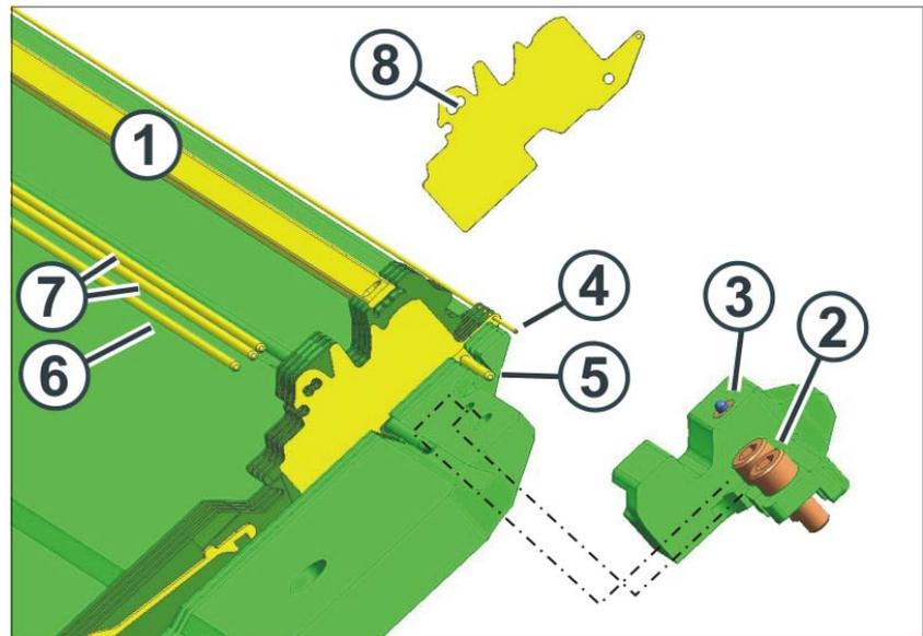
Fig. 6-14 Austausch einer Drahtstütze
