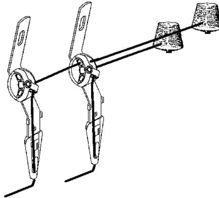
Fig. 3-14 Einfädeln in mehrere Fadenführer einer Spur
