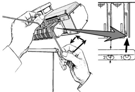
Fig. 3-12 Weg des Fadens durch das STIXX-Gerät
