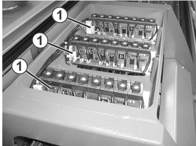
Fig. 6-58 Elektronikkarten zur Steuerung der Fadenführermagnete
