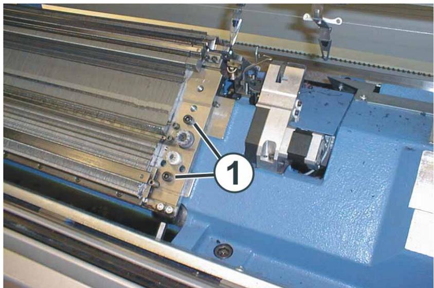
Fig. 6-17 Lösen des Nadelbetts
