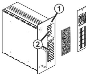
Fig. 5-14 Lüfter Netzteil
