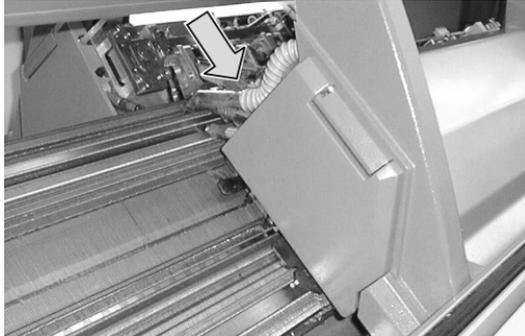
Fig. 2-14 Flusenentsorgung und Flusenbehälter
