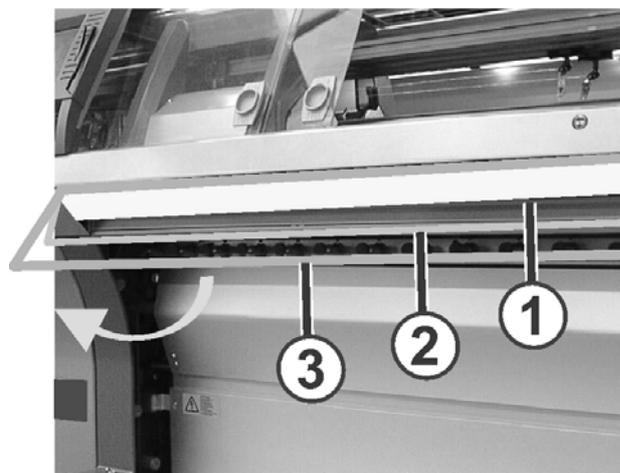
Fig. 2-32 Einrückstange
