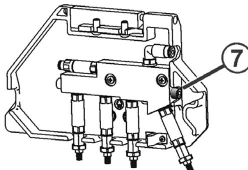
Fig. 6-54 Zentralschmierung entlüften
