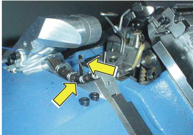
Fig. 5-16 Klemm- Schneidnadel und Klemmritzel
