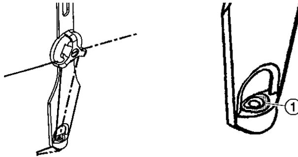
Fig. 4-63 Langloch des Plattierfadenführers
