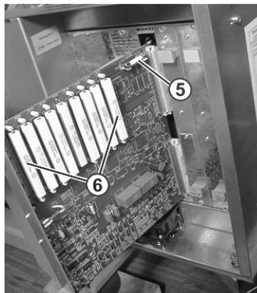
Fig. 6-61 Ballastsicherung (5) für Servo-Antrieb und Versatz am Steuergerät rechts
