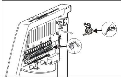
Fig. 5-10 Reinigen der Permanentbremse
