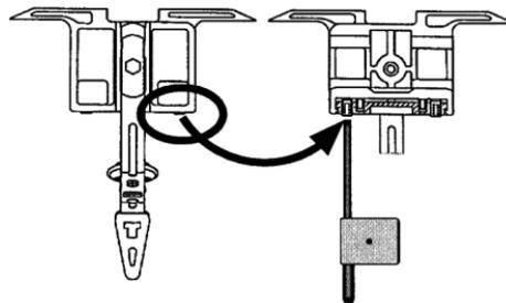
Fig. 4-57 Einstellen der Führung des Fadenführers
