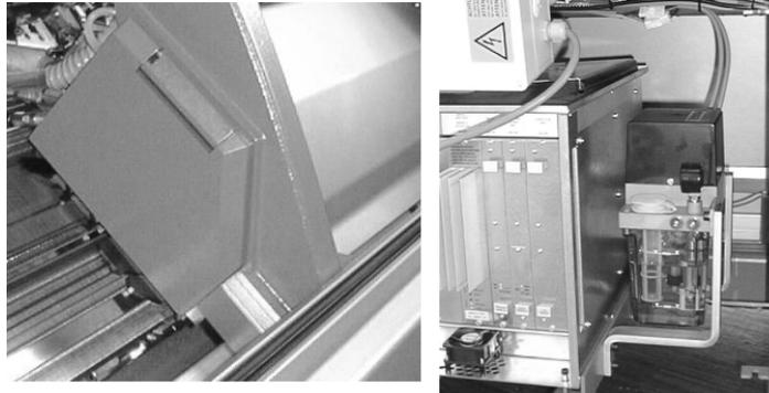
Fig. 2-16 Zentralschmierung am Schlitten, rechts: Ölversorgung
