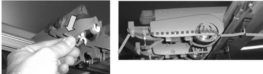
Fig. 3-11 Weg des Fadens durch die Fadenkontrollleinrichtung
