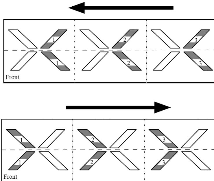
Fig. 4-46 Nummerierung der Abzugsteile für eine 3-systemige Maschine
