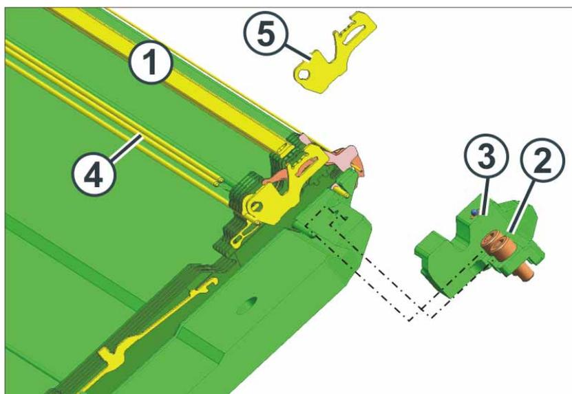
Fig. 6-13 Austausch einer Nadelführung
