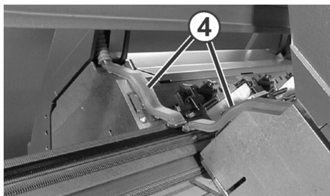
Fig. 5-7 Saugrohr
