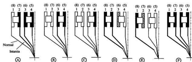
Fig. 6-45 Kombinationsmöglichkeiten für Normal- und Intarsienfadenführer
