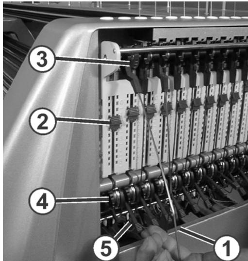
Fig. 4-7 Einstellen der Fadenspannung
