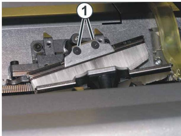
Fig. 4-59 Schrauben der Nadelbürsten
