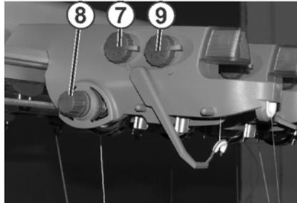
2. Knotenfühler für große Knoten (7) und für kleine Knoten (9) abhängig von Garnstärke und Knoten so einstellen, dass sie bei unerwünschter Knotengröße auslösen.
