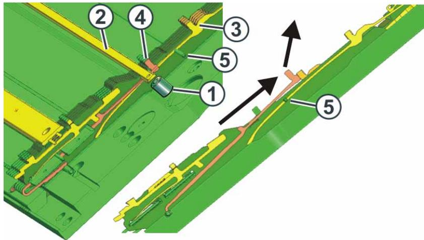
Fig. 6-7 Wechseln des Zwischenschiebers
