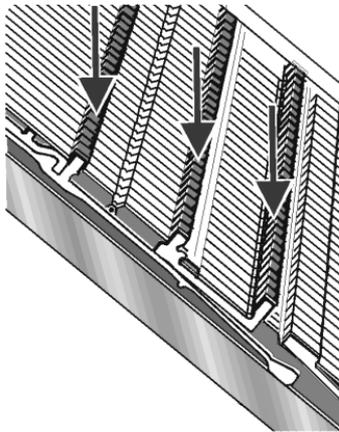
Fig. 5-38 Fetten der Füße von Kupplungsteil und Zwischenschieber
