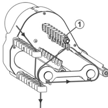
Fig. 4-8 Einstellung der Fadenlieferung am Friktionsfournisseur
