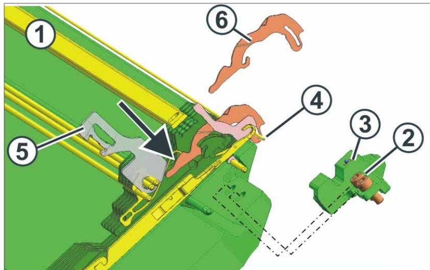
Fig. 6-10 Austausch einer Niederhalteplatine
