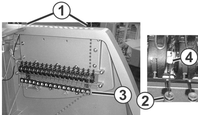
Fig. 3-13 Weg des Fadens durch die seitliche Sicherheitshaube
