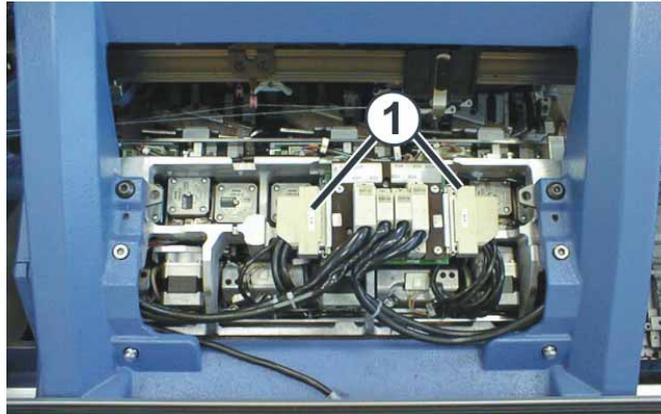
Fig. 6-36 Stecker (Schrittmotoren, Auswahlssysteme)
