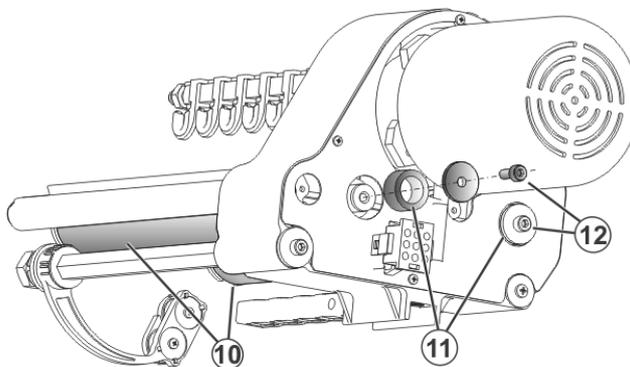
Fig. 6-52 Schrauben für Friktionswalzen
