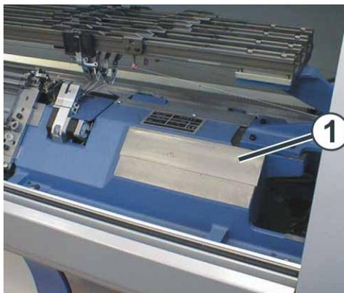
Fig. 6-34 Auflagefläche des Schlittenteils
