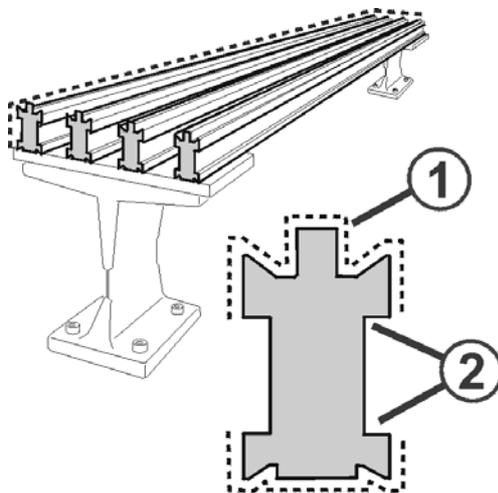
Fig. 5-40 Fetten der Fadenführerstäbe
