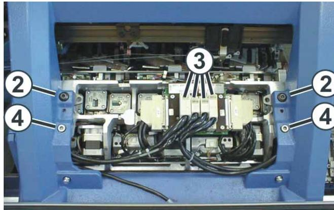
Fig. 6-35 Befestigung des Schlittenwagens am Schlittenteil
