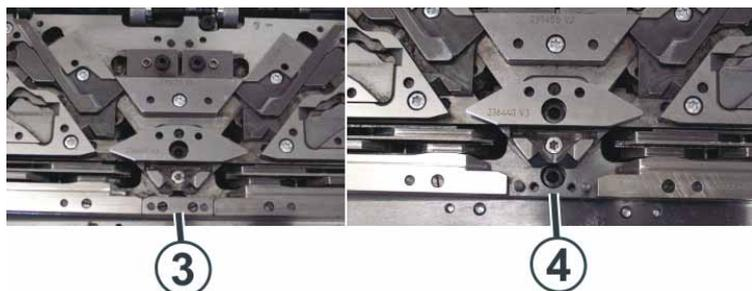
Fig. 6-38 Schrauben unter Schlossteilen
