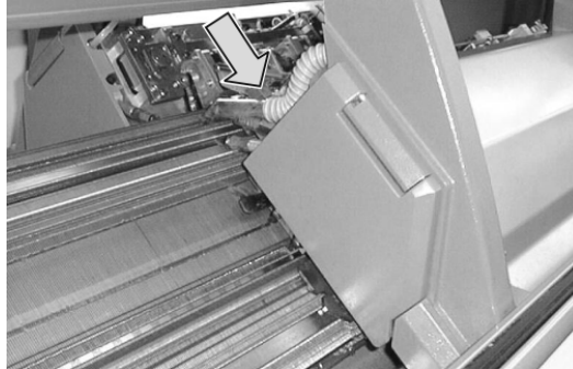
Fig. 2-14 Dispositif d'élimination des peluches et récipient à peluches L'aspiration enlève les peluches de fil de la partie supérieure des fontures. Les peluches sont récupérées dans un récipient.
