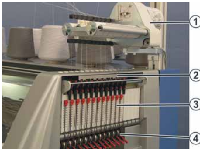
Fig. 2-8 Guidage latéral du fil
