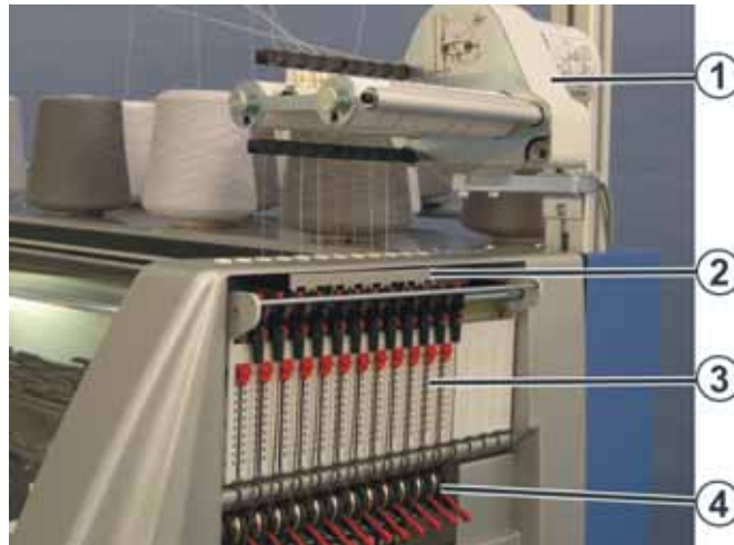
Fig. 2-6 Guidage latéral du fil
