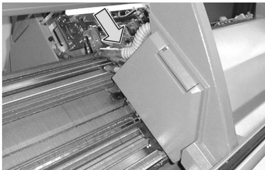
Fig. 2-14 Eliminazione della peluria e contenitore per la peluria
