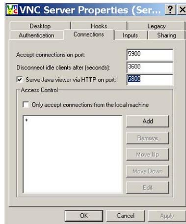
Fig. 10-3 Finestra "VNC Server Properties (Service Mode)" con il registro "Connections"
