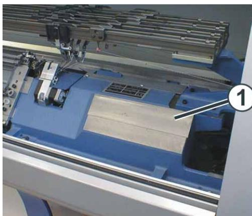
Fig. 6-33 Superficie di appoggio della slitta
