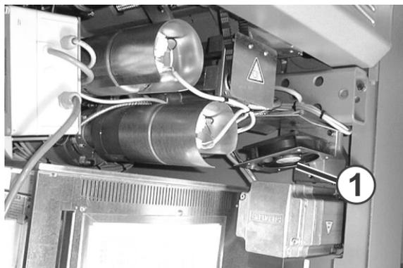
Fig. 5-12 Ventilatore del comando principale
