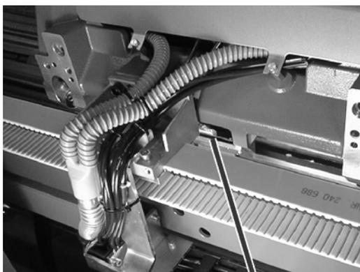
Fig. 2-24 Generatore di impulsi
