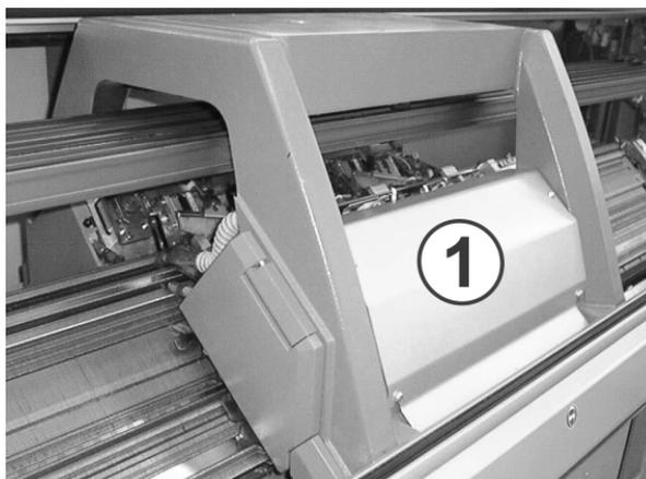
Fig. 6-24 Rivestimento del carro
