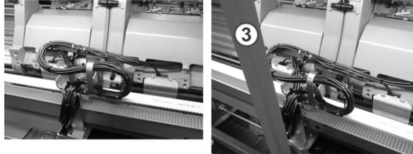
Kabelstrang in Haltebügel einlegen
