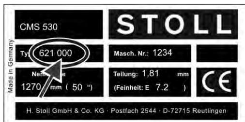
Die erste Zahlenkolonne im Feld "Typ" zeigt den Maschinentyp an, die zweite Zahlenkolonne zeigt das Baumuster an. Im obigen Beispiel handelt es sich um eine Maschine des Typs "621", Baumuster "000".
