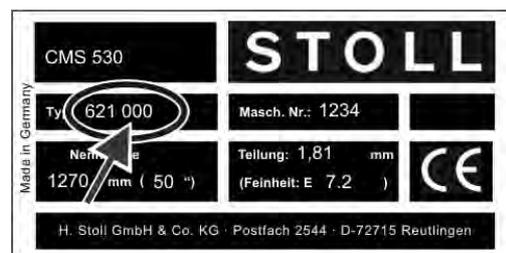
Typenschild der Maschine
