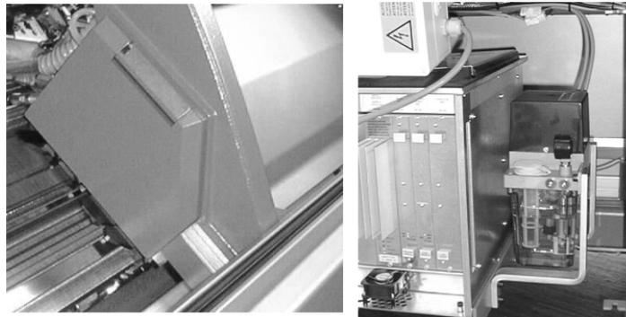
Zentralschmierung am Schlitten, rechts: Ölversorgung
