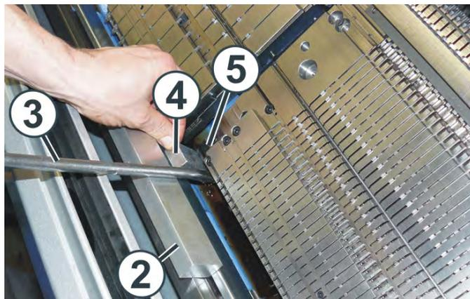
10. Mit einem Hebel (3) das Nadelbett soweit anheben, bis das Abstandsstück (4) vollständig unter die Nadelbett-Stütze (5) geschoben werden kann.
