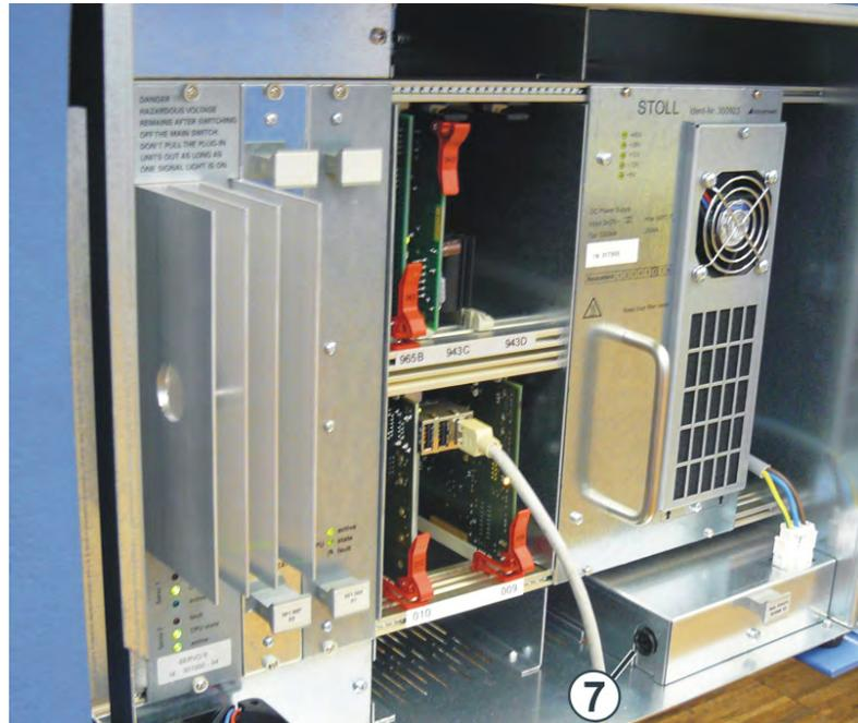
Batteriesicherung unterhalb des Netzgerätes
