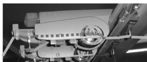
Fgra. 51: Recorrido del hilo a través de la unidad de control del hilo
