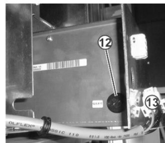
Fusible de batería (12) debajo de la fuente de alimentación
