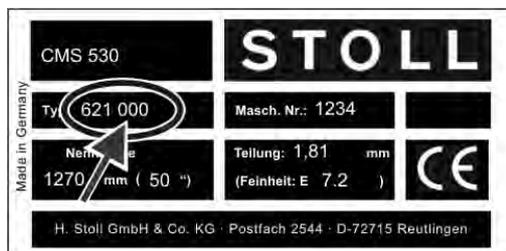
I numeri della prima colonna nel campo "Tipo" indicano il tipo macchina, i numeri della seconda colonna indicano il modello. Nell'esempio qui sopra si tratta di una macchina del tipo "621", modello "000".
