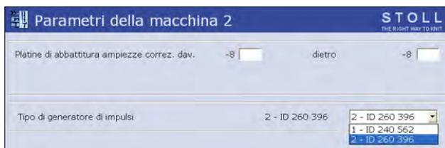
6. Selezionare il tipo di generatore di impulsi "2 – ID 260 396". Selezionare questa impostazione anche in caso di funzionamento ibrido (generatore di impulsi di tipo precedente e nuovo).
