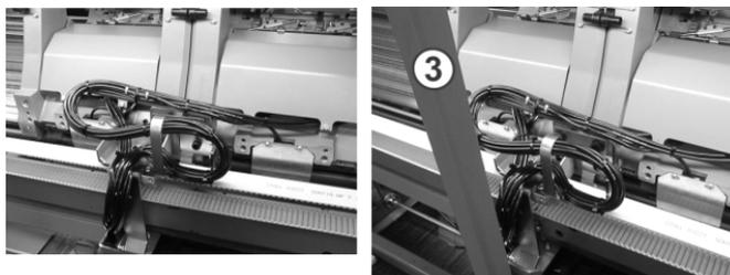
Fissaggio del fascio di cavi nella staffa di supporto
