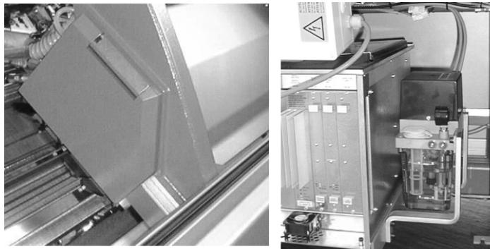
Lubrificazione centralizzata sul carro, a destra: Alimentazione d'olio
