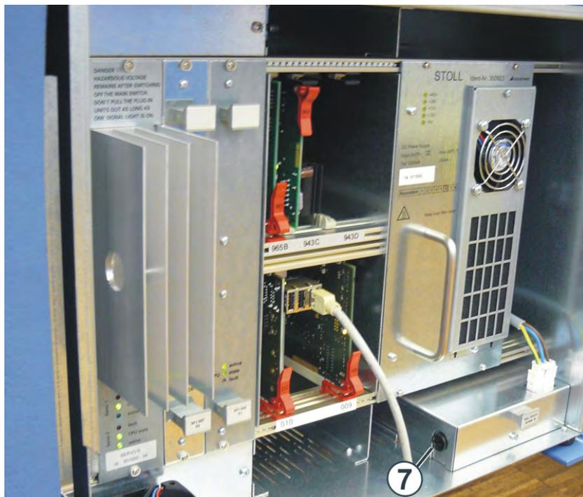
Fusibile della batteria sotto l'alimentatore
