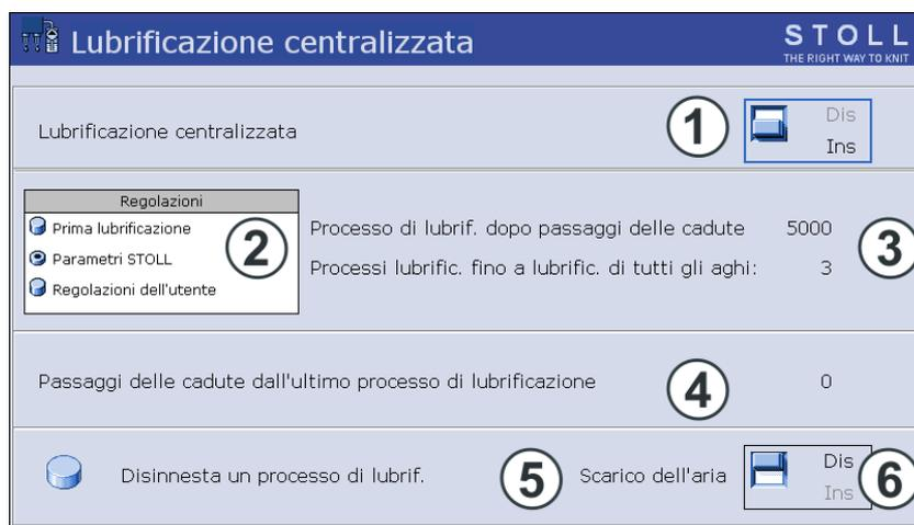
Finestra "Lubrificazione centralizzata"
