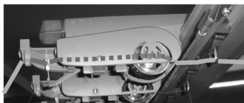
Рис. 51: Заправка нити через устройство контроля нити
