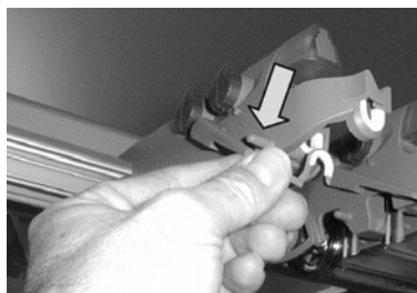
Рис. 51: Заправка нити через устройство контроля нити
