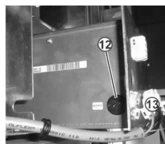
Предохранитель (12) батареи аккумуляторов под блоком питания
