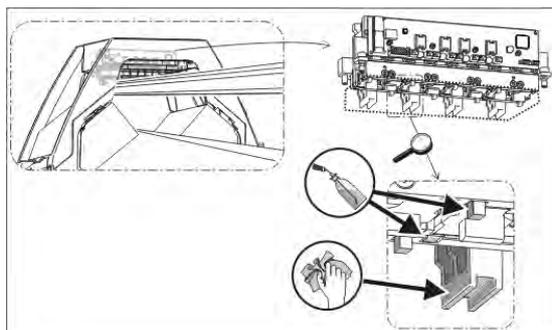
1. Mit einem Pinsel Öl auf den Hubschieber auftragen.
