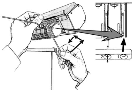
Weg des Fadens durch das Fadenlängenmessgerät
