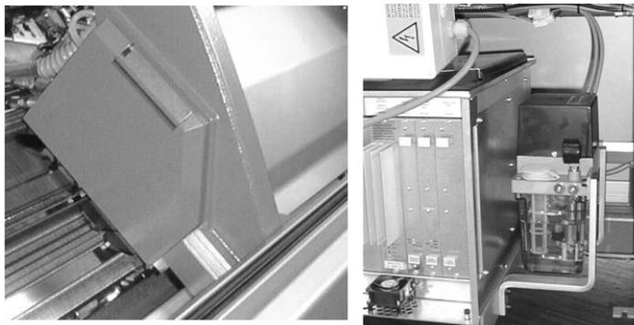
Zentralschmierung am Schlitten, rechts: Ölversorgung
