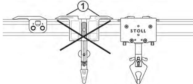
Grund: Die Aushebearme (1) am Normal-Fadenführer kollidieren mit dem Intarsia-Fadenführer oder dem Fadenführerbegrenzer.
