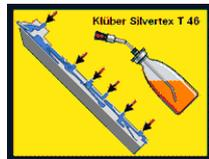
1. Mit einem Pinsel oder einer Sprühflasche Öl auftragen.
