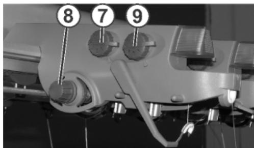
2. Knotenfühler für große Knoten (7) und für kleine Knoten (9) abhängig von Garnstärke und Knoten so einstellen, dass sie bei unerwünschter Knotengröße auslösen.
