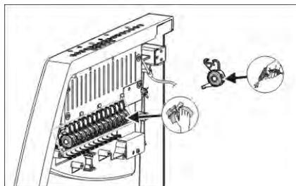
Reinigen der Permanentbremse
