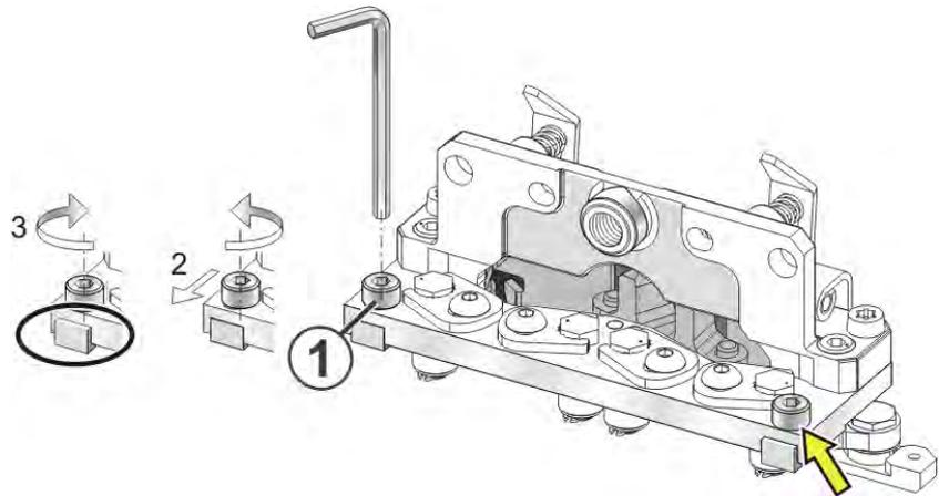
2. Mit Hilfe des Innensechskantschlüssels die Schraube, und damit den Flottungsschieber, nach unten schieben.
