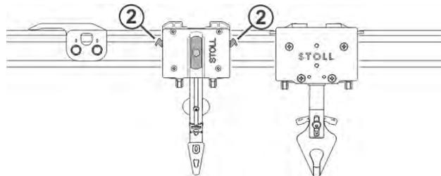
Er besitzt keine Aushebearme, sondern Ausheber (2), ähnlich wie der Intarsia-Fadenführer. Somit kann dieser Fadenführer zusammen mit Intarsia-Fadenführern auf derselben Spur eingesetzt werden.
