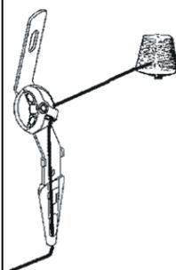
Wenn mehrere Fadenführer einer Spur verwendet werden und die Fäden den Fadenführern von derselben Seite zugeführt werden.
