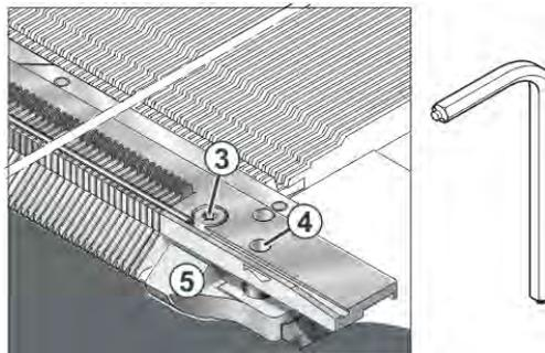
4. Schraube (4) auf der linken und rechten Seite des Platinenbetts lösen.
