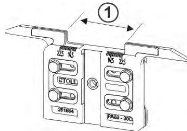
Für das Plattieren mit Normalfadenführern werden zwei Fadenführer verwendet, welche sich durch die Eingriffsweite (1) am Fadenführer-Schlitten unterscheiden. Bei diesem Fadenführer-Schlitten ist die Eingriffsweite individuell einstellbar (23-46 mm).
