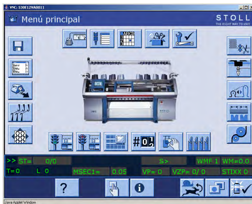
Visualización de la interface gráfica de la máquina en la ventana "Java Applet"
