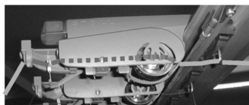
Recorrido del hilo a través de la unidad de control del hilo
