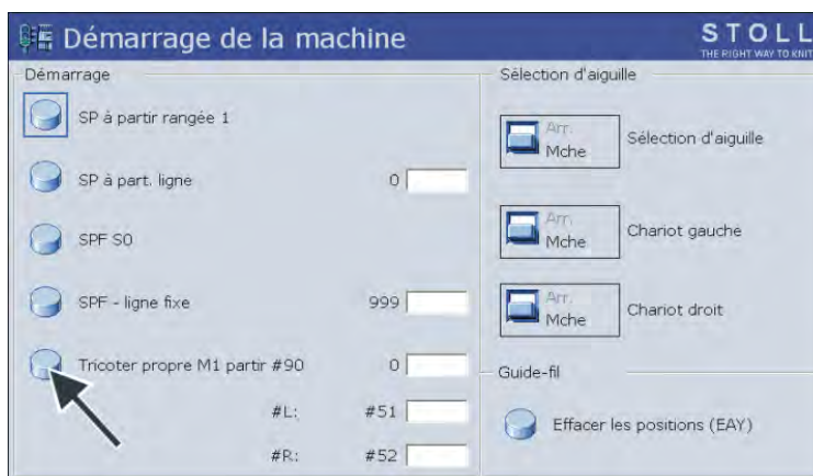
Fenêtre "Démarrage de la machine"
