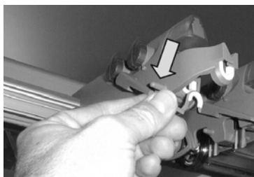
Chemin du fil à travers l'unité du contrôle du fil
