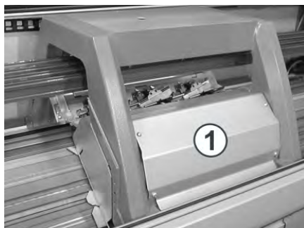
Rivestimento del carro
