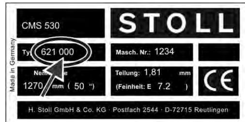
“类型”区域的第一组数字表示机器类型，第二组数字表示部件类型。在上面示例中，机器类型为“621”，部件类型为“000”。
