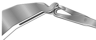
Posición de transferencia de la pieza de transferencia y la cabeza de la aguja
