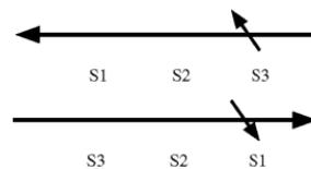
Proceso de transferencia por arriba: Primera carrera hacia la izquierda; abajo: Segunda carrera hacia la derecha
