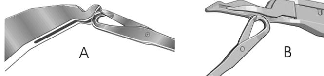
Posición de transferencia de la pieza de transferencia y la cabeza de la aguja
