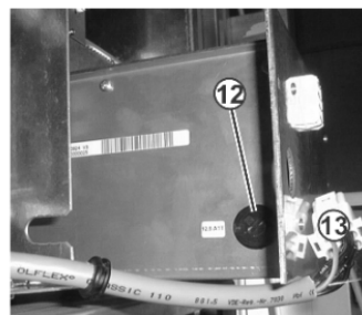
Предохранитель (12) батареи аккумуляторов под блоком питания
