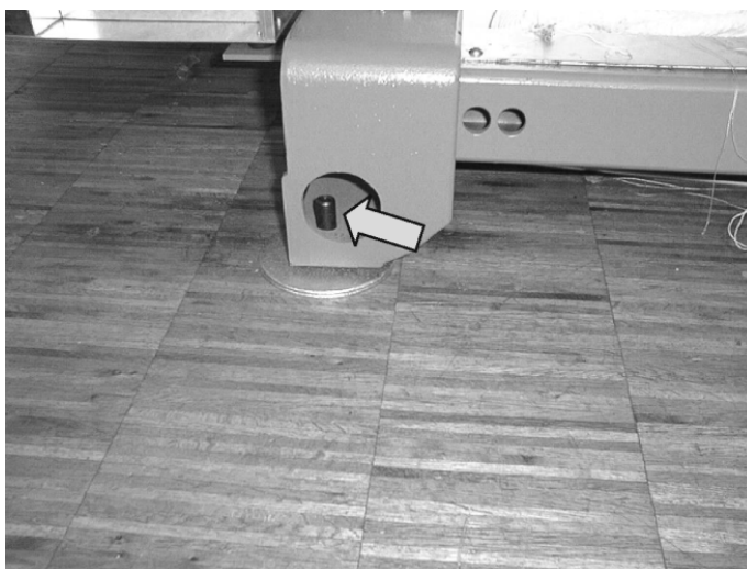
用于调机器水平的调节螺丝
