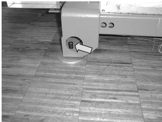
Gewindestifte zum Ausrichten der Maschine
