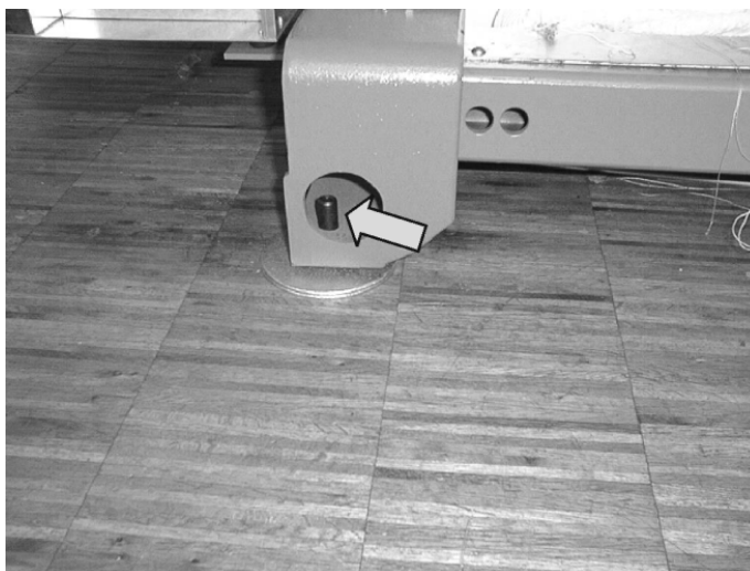
Pasadores roscados para la alineación de la máquina
