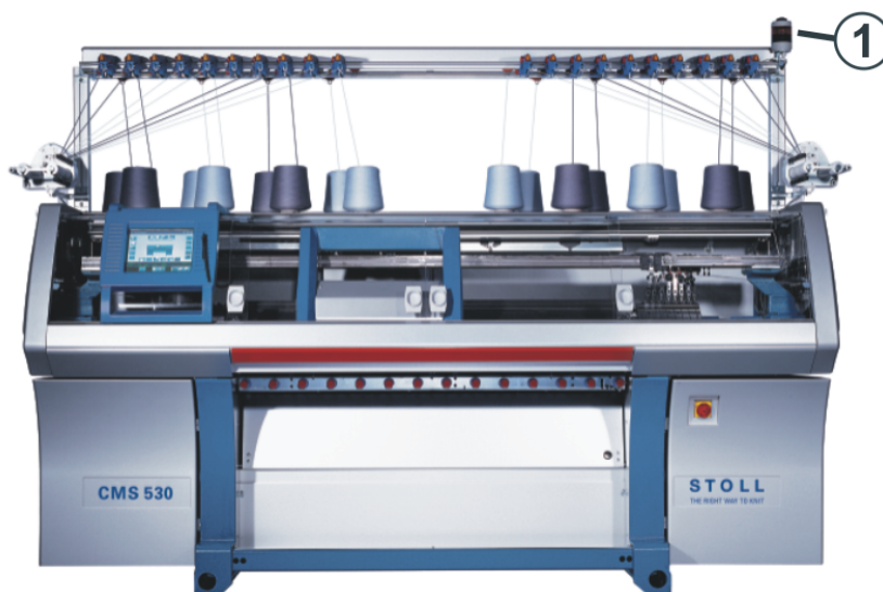
Lâmpada de sinalização do estado da máquina
