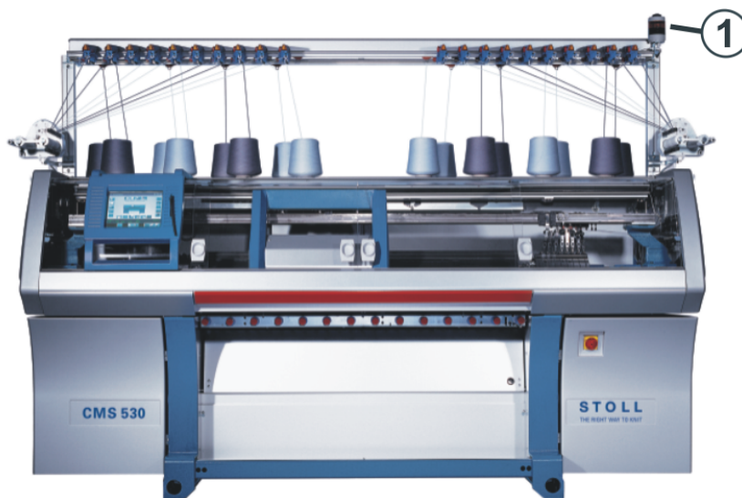
Lâmpada de sinalização do estado da máquina
