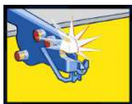
Сигнальная стойка устройства контроля нити
